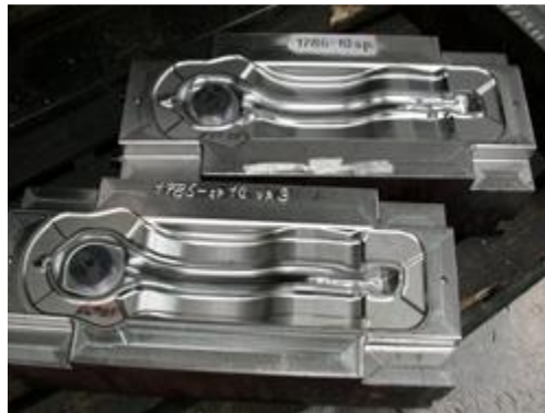
Figura 19 Dado para Forja, dado progresivo para la fabricación de bielas
