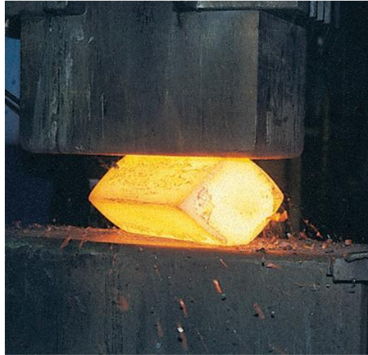
Figura 17 Ejemplo 1 del herramental utilizado para forja libre
