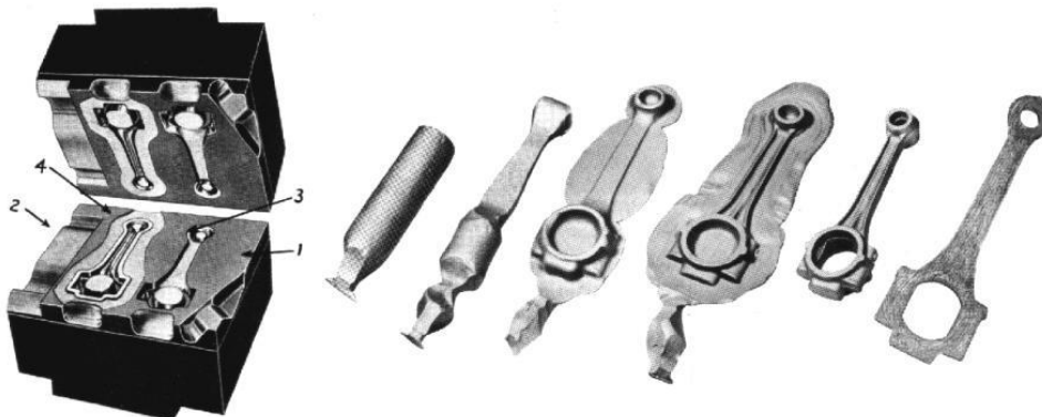
Figura 20 Dado para Forja, dado progresivo para la fabricación de bielas
