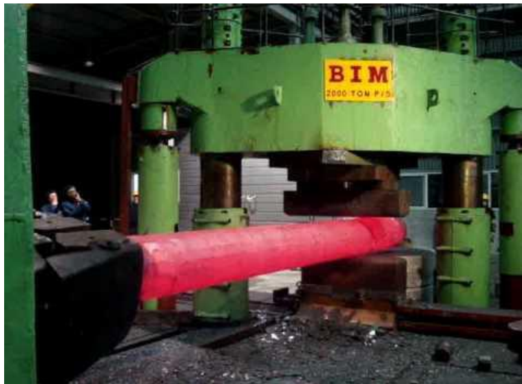
Figura 18 Ejemplo 2 del herramental utilizado para forja libre
