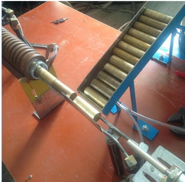
Figura 10 Alimentador Jinlai - Vista de línea
