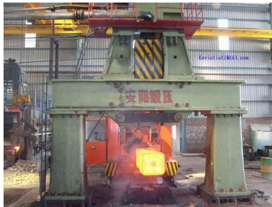
Figura 15 Forja libre o abierta (a)
