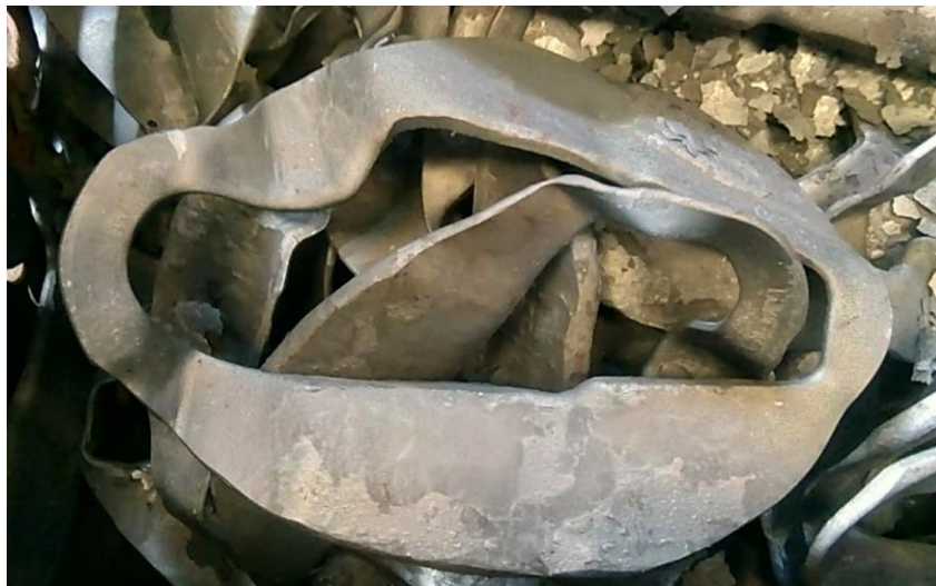
Fig 8: Sobrante de una pieza forjada después del corte y a temperatura ambiente
