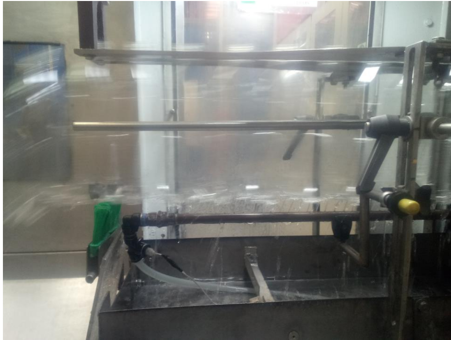
Imagen 5.3 Contenedor de agua helada
