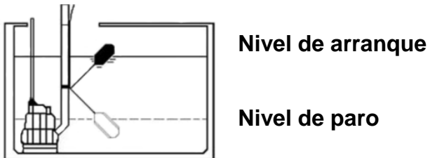
Fig. 3.7 Contenedor de agua con sistema de bombeo
