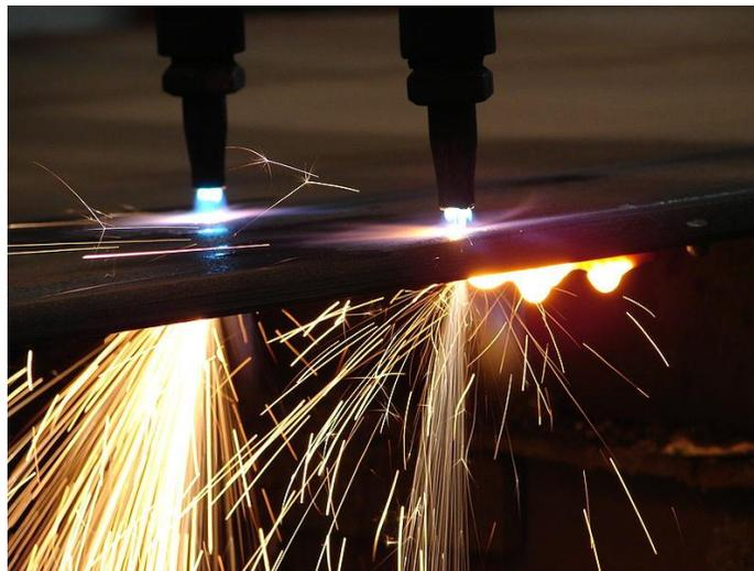
Ilustración 2-12. Corte de acero por oxicorte.
