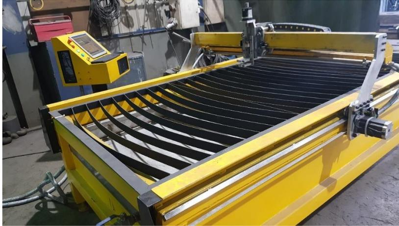
**Ilustración 2-15. Máquina cortadora CNC.**
