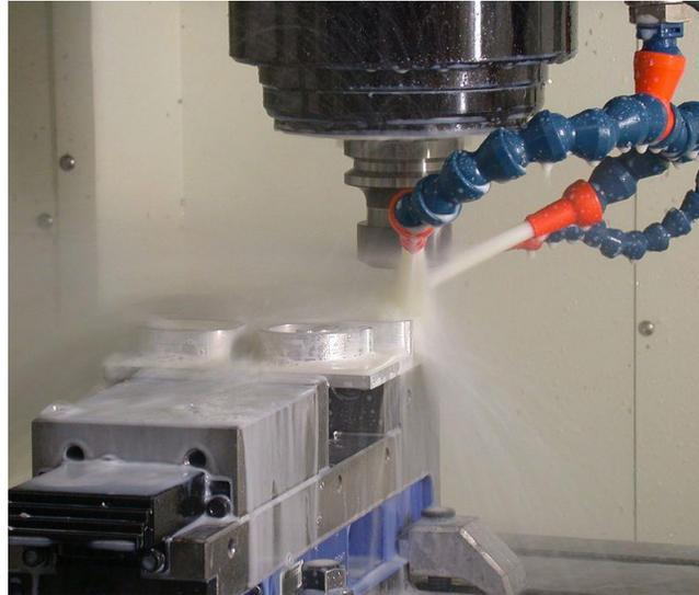
**Ilustración 2-9. Proceso de maquinado por fresado.**
