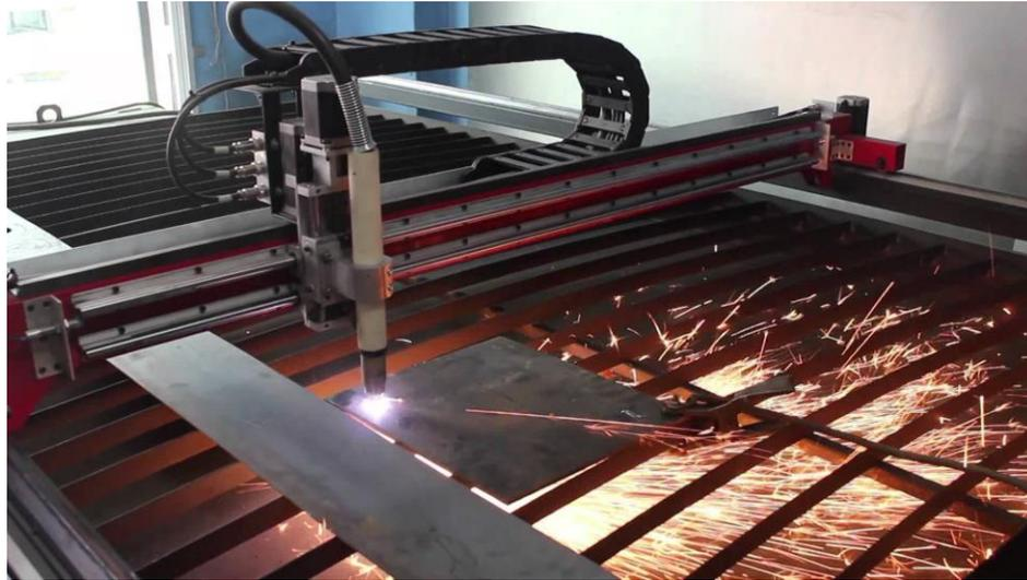
**Ilustración 2-16. Máquina CNC con cortador de plasma.**
