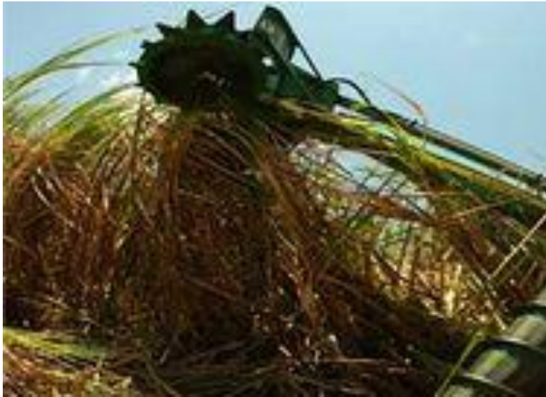
Figura 2.17 Corte Mecanizado Del Cogollo De La Caña (John Deere)
