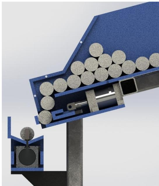
Figura 4.6 Vista de sección de alimentadora
