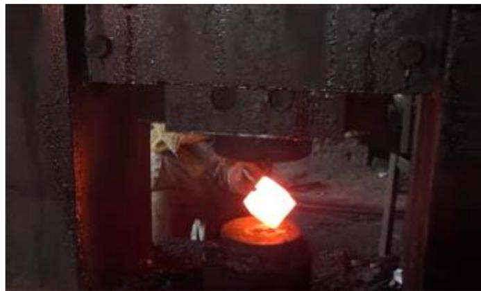
Figura 3.5 Forjado de pieza
