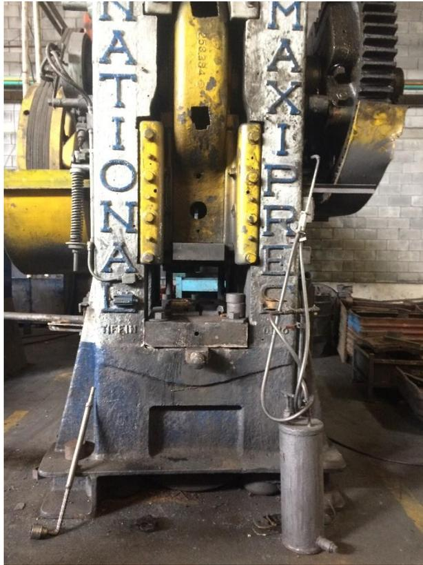
Figura 3.4 Prensa 750 para forja
