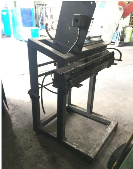
Figura 4.4 Soporte de alimentadora dañada
