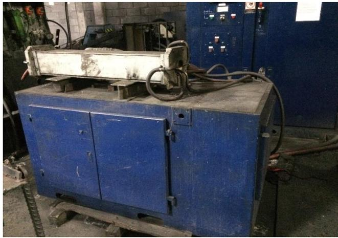
Figura 3.2 Bobina de horno de inducción
