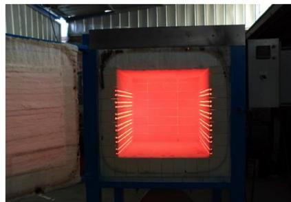
Figura 2.3 Horno eléctrico por resistencia
