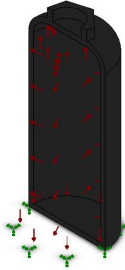
Ilustración 40. Corte seccional de análisis estático de presión.
