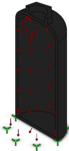
Ilustración 2. Corte seccional de análisis estático de presión.
