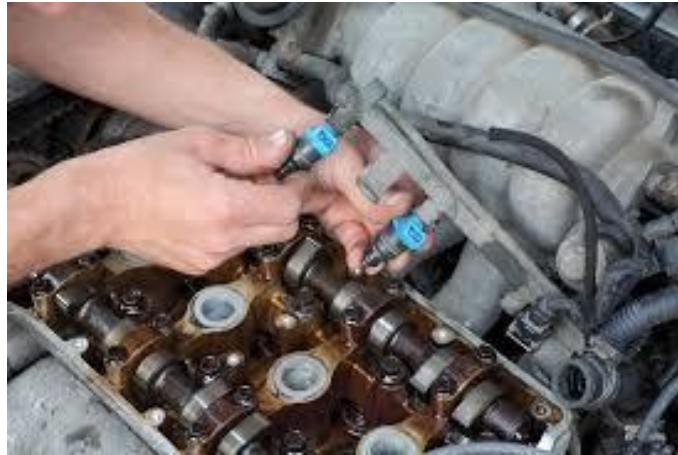
Ilustración 19. Desmante de inyectores.
