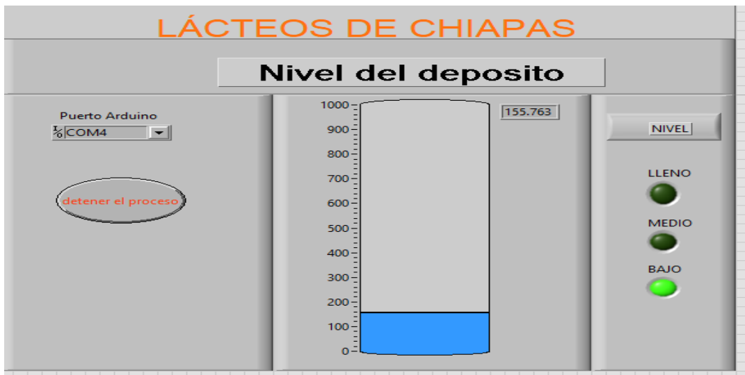
Ilustración 79 llenado del depósito nivel bajo
