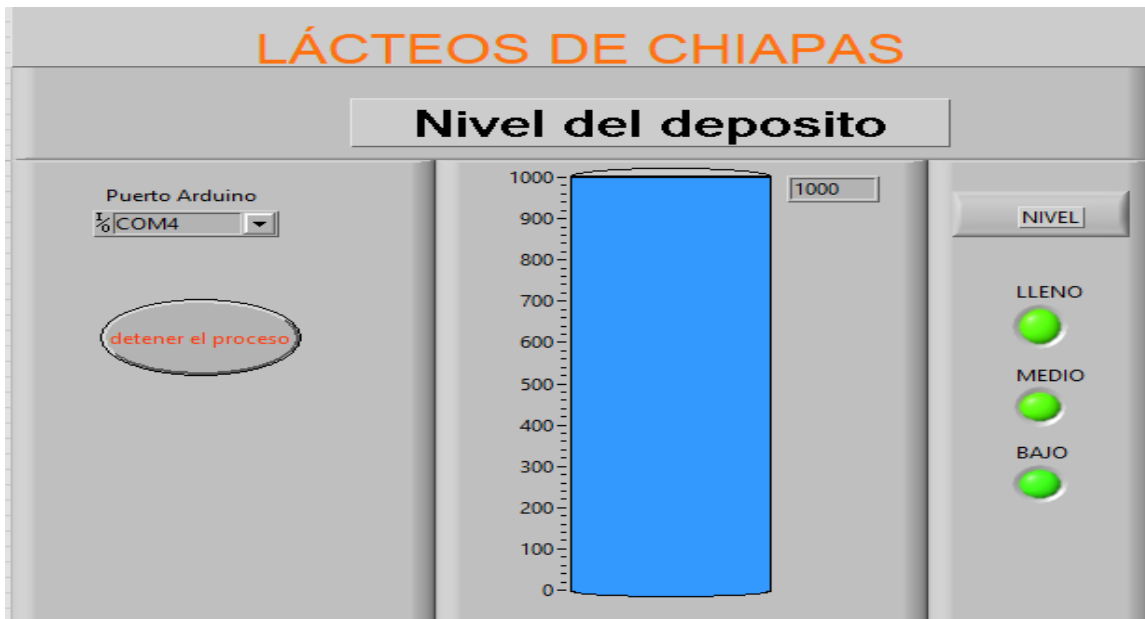
Ilustración 81 llenado del depósito nivel lleno
