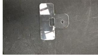
Figura 28 Base de acrílico del sensor.
