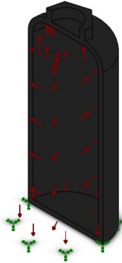
Ilustración 40. Corte seccional de análisis estático de presión.
