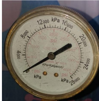
Ilustración 35. Manómetro de 4000 psi.
