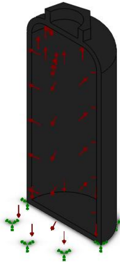
Ilustración 2. Corte seccional de análisis estático de presión.
