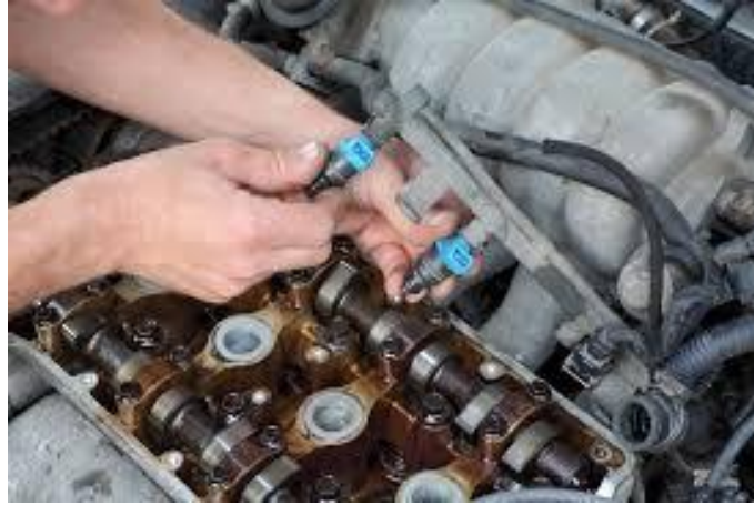
Ilustración 19. Desmante de inyectores.
