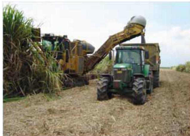
***Ilustración 9. Cortador y transportador de la caña de azúcar.***
