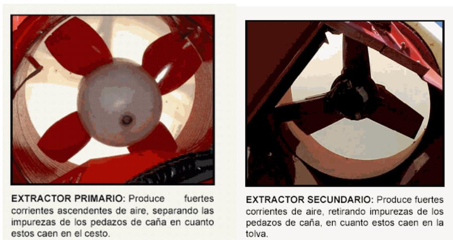
**EXTRACTOR PRIMARIO:** Produce fuertes corrientes ascendentes de aire, separando las impurezas de los pedazos de caña en cuanto estos caen en el cesto.
