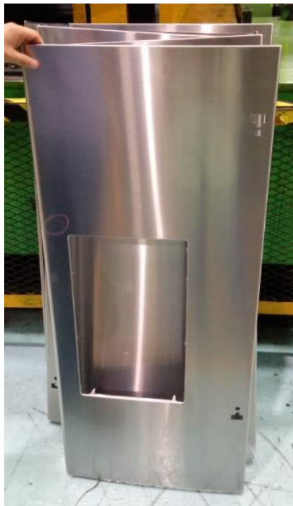
Figura 13. Lámina previamente troquelada y doblada.
