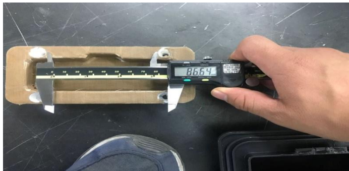
Figura 26. Medición con vernier digital
