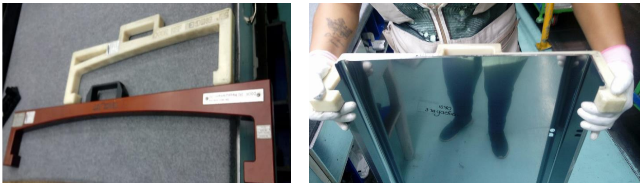
Figura 25. JIG para medición de puertas
