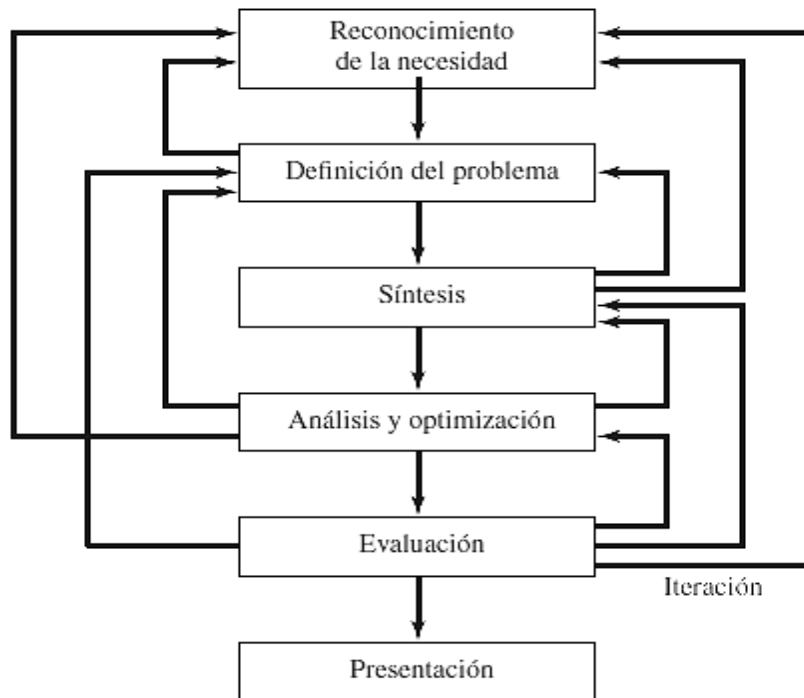
Figura 18. Fases del proceso de diseño que reconocen múltiples retroalimentaciones e iteraciones.
