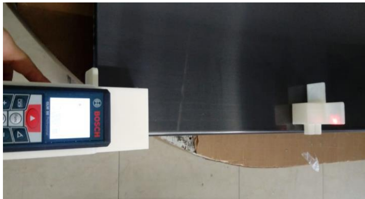
Figura 52. Medición de la distancia al primer troquelado.
