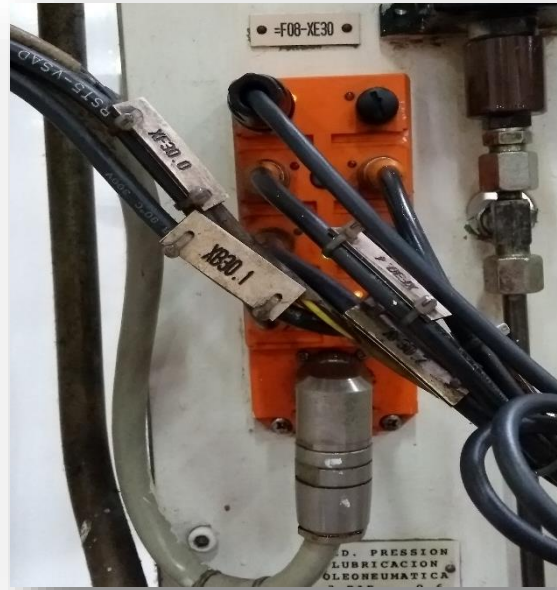
Ilustración 30 Conexión del sensor al interfaz
