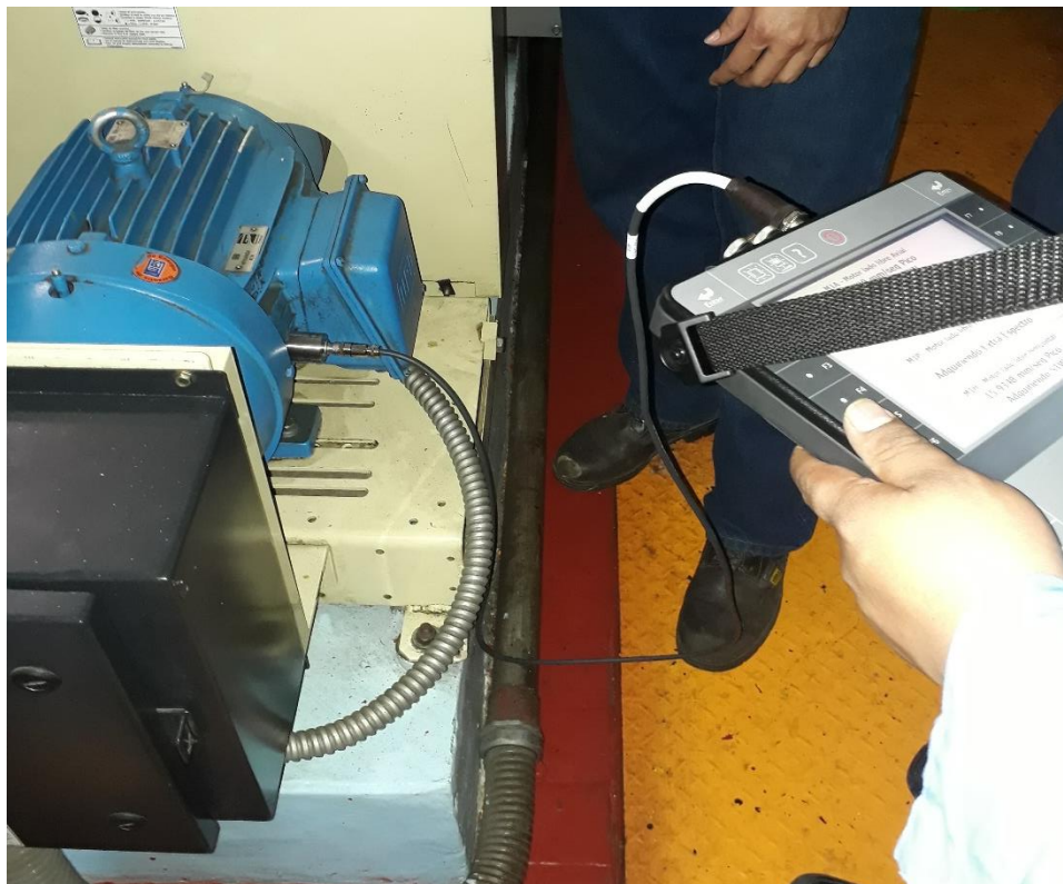
Figura 47 Toma de vibración equipo Auxiliar
