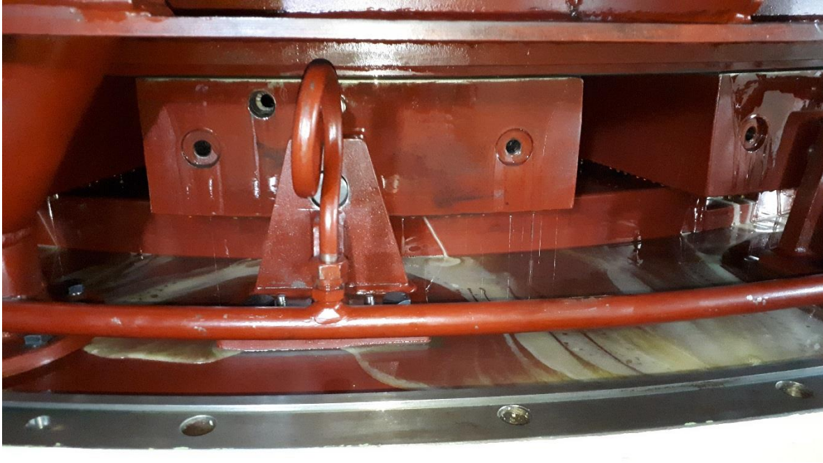
Figura 33 Lubricación de los segmentos de la chumacera
