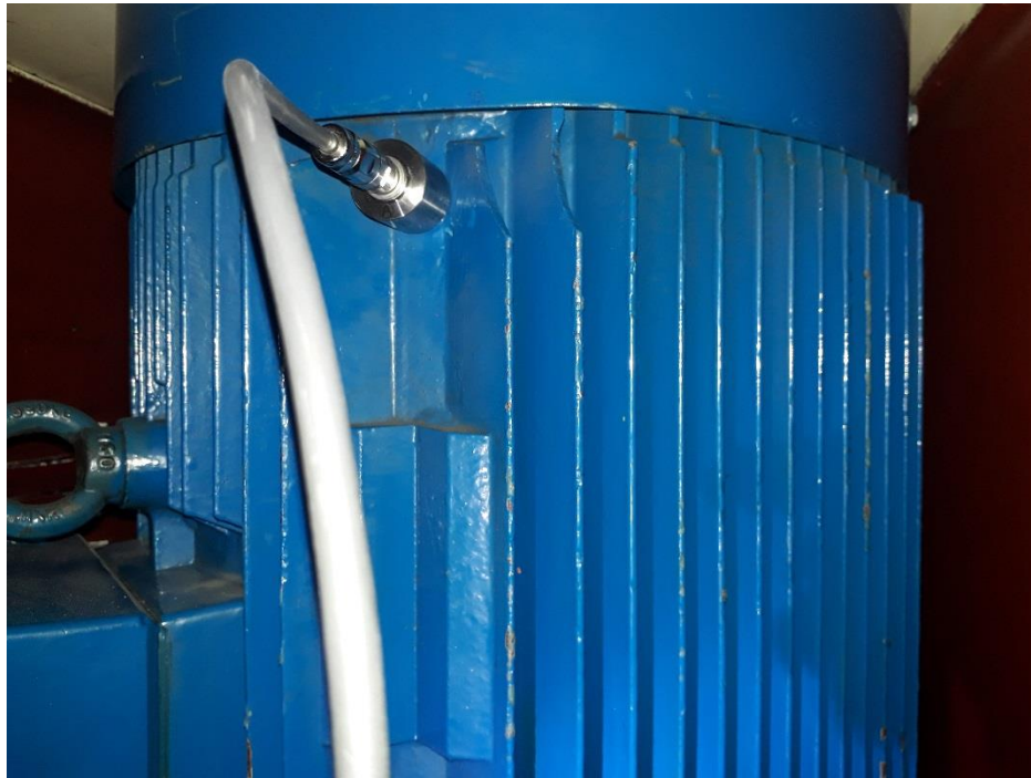
Figura 46 Medición de vibración a equipo principal
