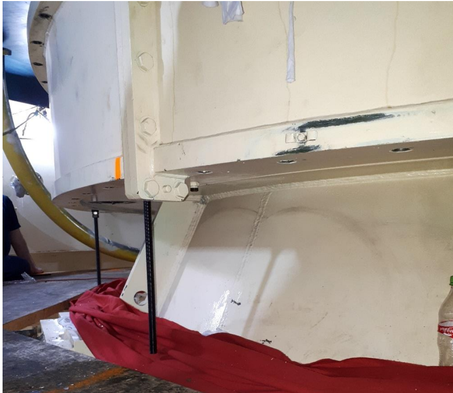
Figura 35 Espárragos utilizados para bajar la tapa inferior del depósito de aceite.
