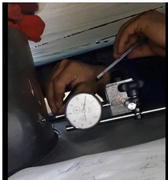
Figura 38 Toma de medidas con lainometros e indicadores de caratula.
