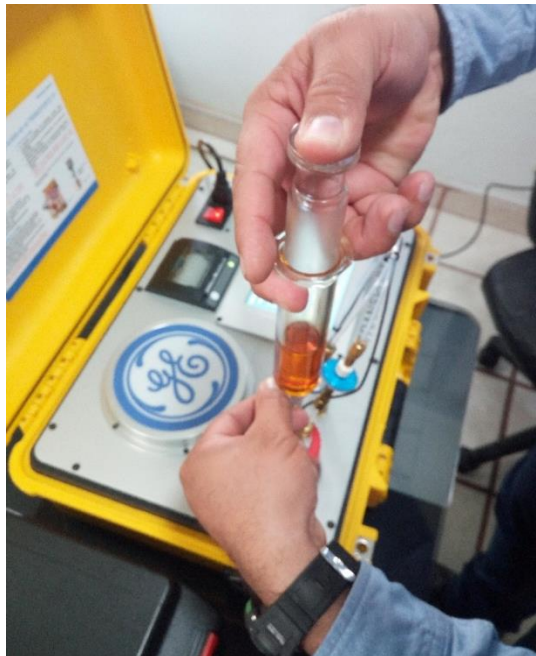
Fig. 4. 27 Inyección de muestra a contenedor para la prueba
