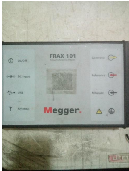
Fig. 4. 8 Megger Frax 101 empleado para realizar el barrido a la frecuencia
