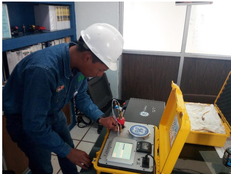
Fig. 4. 25 Realizando conexionado de terminales en el Transport X
