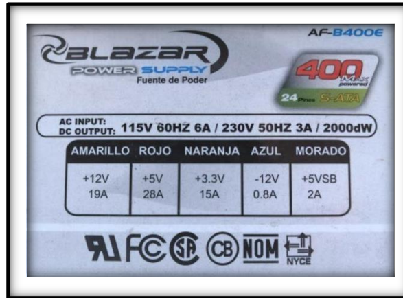
Fig.3.2.2.0 (Salidas de voltaje y Amperes de la fuente) COTOC, I. (2019). Fotografía de fuente
