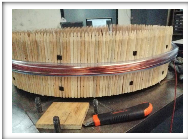
Fig.3.3.3.1. Bobina en el tubo de plástico sobre el molde COTOC, I. (2019). Fotografía
