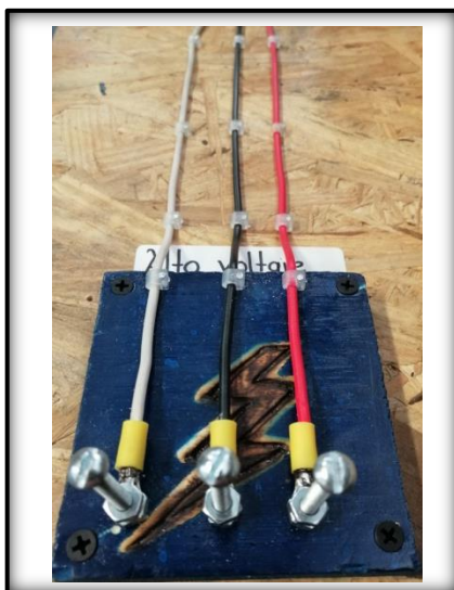
Fig.3.3.10.1 Terminales para conectar UT-243 COTOC, I. (2019). Fotografía
