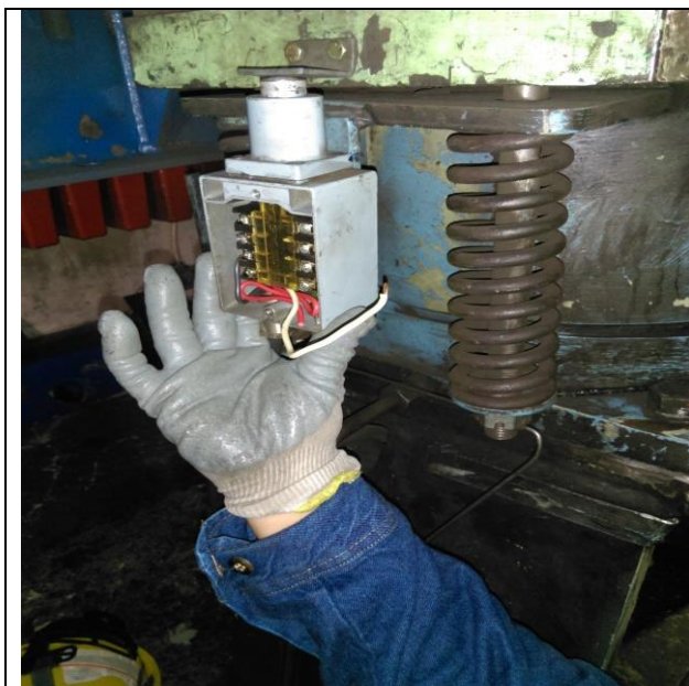
Figura 55: Retiro del micro en la pista de frenado.
