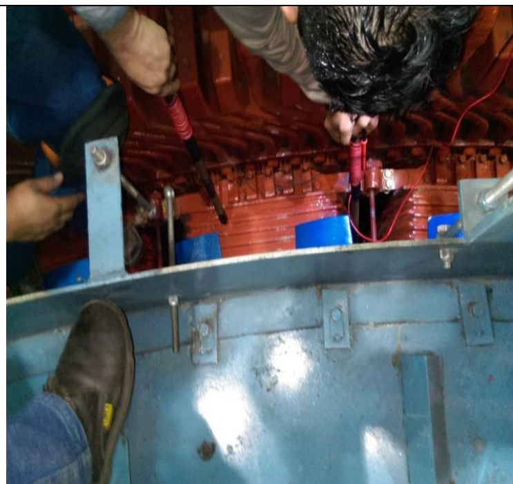
Figura 26: Medición de voltaje polo 44.
