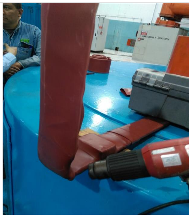
Figura 53: Adherimiento de termocontactil.
