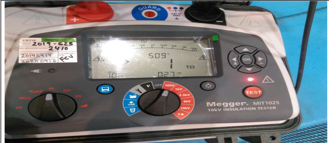
Figura 15: medición de I.A con el dispositivo.
