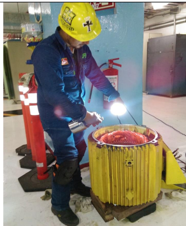
Figura 84: Limpieza con dielectrol al estator.
