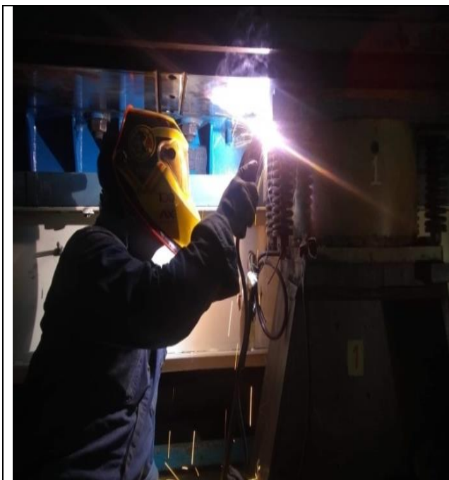
Figura 57: Soldadura de dispositivo de sujeción de micros.
