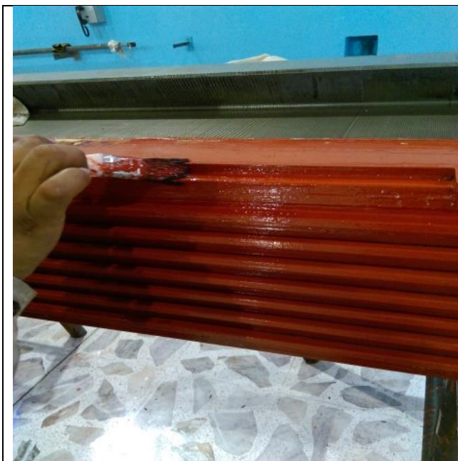
Figura 48: Lubricación con barniz.
