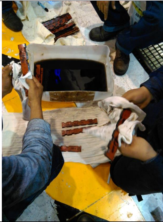
Figura 43: Limpieza de cuñas.
