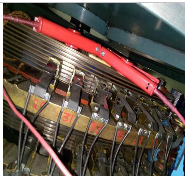
Figura 22: Conexión del dispositivo a los anillos.
