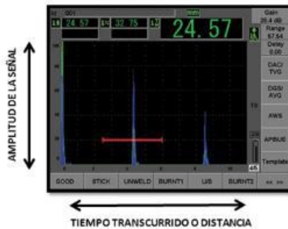
Figura 9. Presentación de señales ultrasónicas en formato A-Scan.
