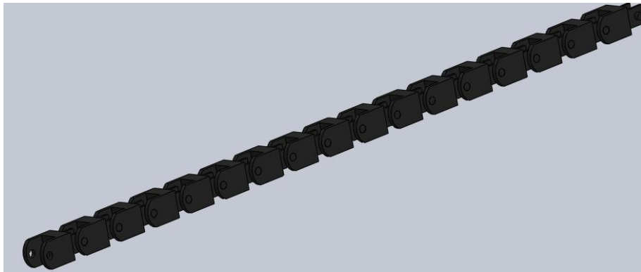
Figura 59. Juego de eslabones que se utiliza para mantener en orden el cableado de un sistema electrónico o eléctrico.
