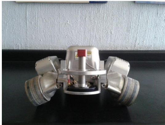
Figura 17. Dispositivo para medir espesores en tanques de almacenamiento, fuera de operación.
