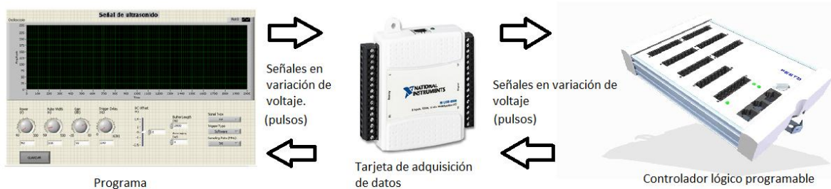
Figura 19. Comunicación entre el programa y el controlador lógico programable mediante una tarjeta de adquisición de datos.
