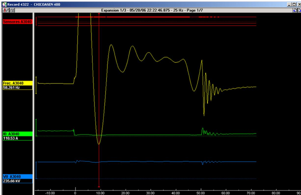
Fig. 48 Medición de la línea A3040 en baja frecuencia
