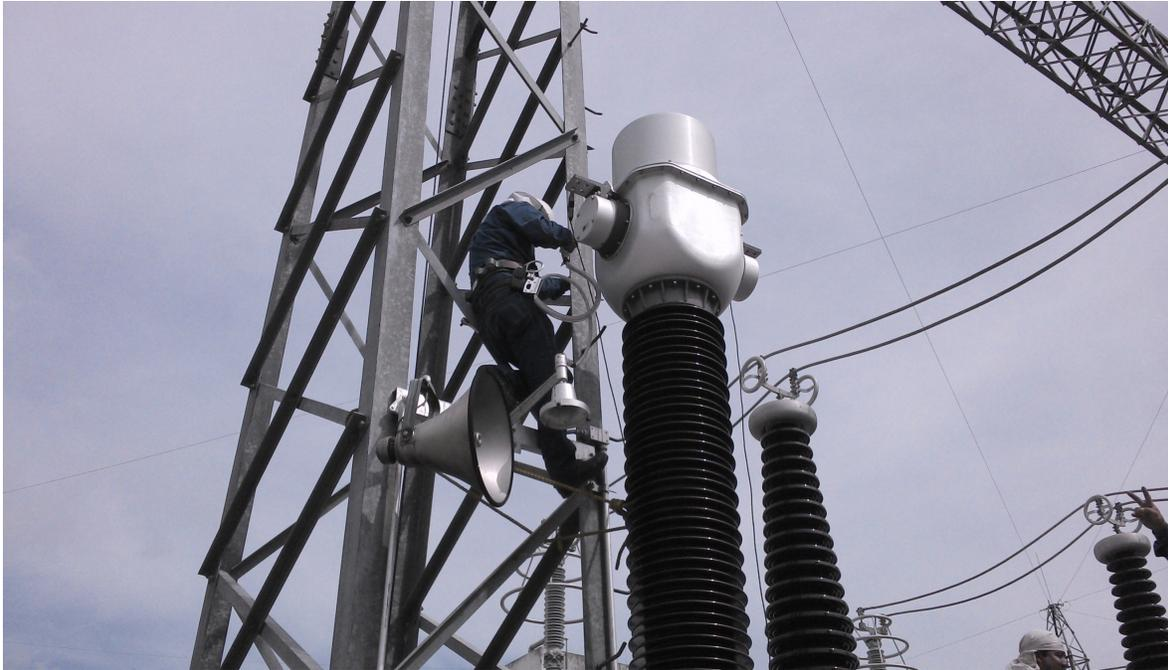
Imagen 33. Pruebas a los Transformadores de Corriente TC's.
