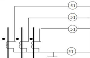
Imagen 10. Transformadores de corriente conectados en estrella.
