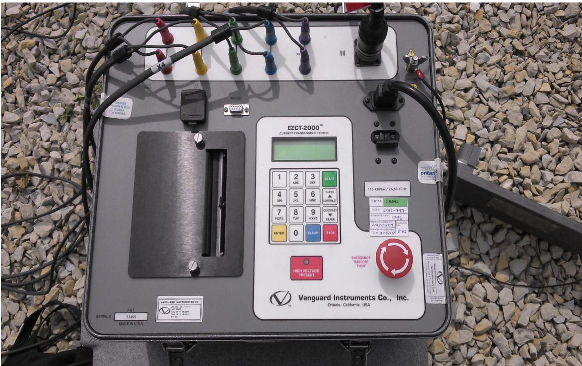
Imagen 34. Instrumento VANGUARD para hacer pruebas a los TC's.
