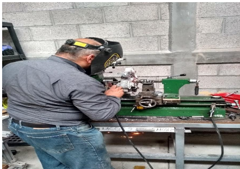
Ilustración 22 construcción de los rodillos para el bombeo del concreto
