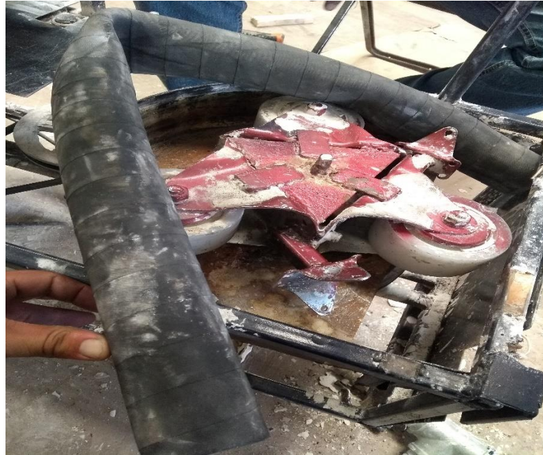
Ilustración 42 proceso de desmontaje de la manguera de bombeo de proyectadora de mezclas
