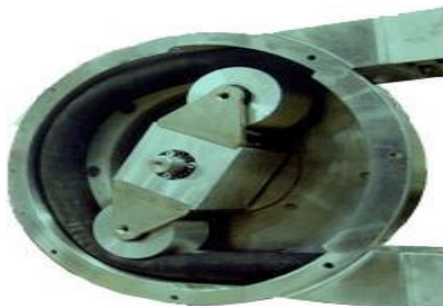
Ilustración 5 interior de una bomba peristáltica
