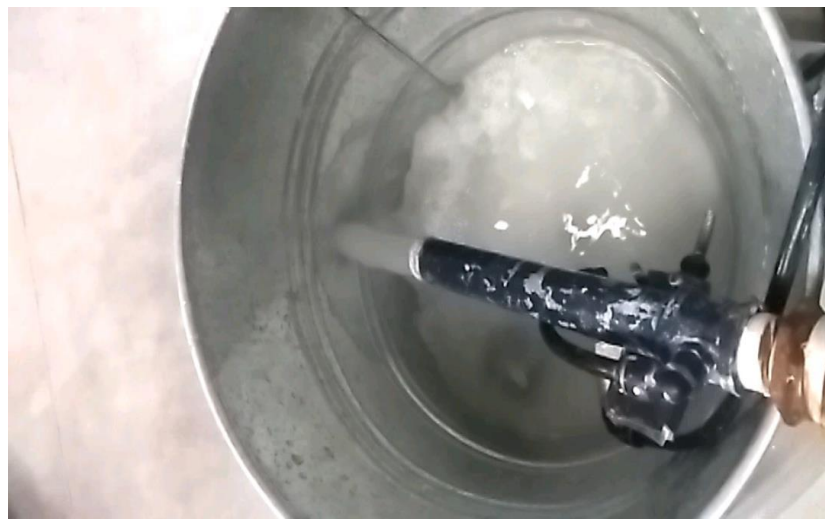
Ilustración 31 funcionamiento de la proyectadora de mezclas con agua
