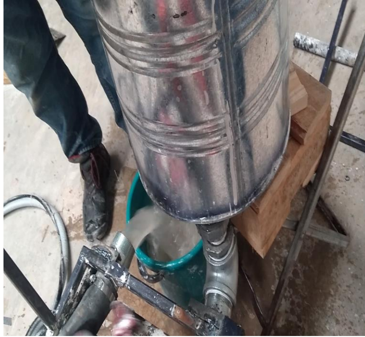
Ilustración 44 limpieza de depósito de mezclas
