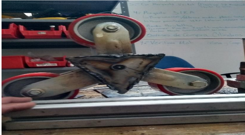
Ilustración 23 rodillos terminados, listos para acoplarse en motor.
