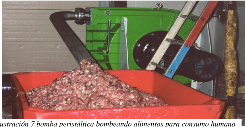
Ilustración 7 bomba peristáltica bombeando alimentos para consumo humano
