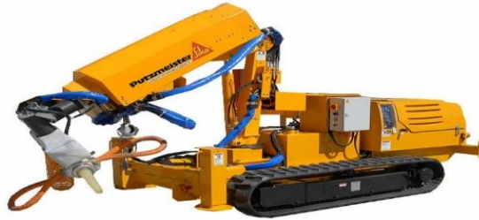
Ilustración 8 unidad oruga de proyección móvil
