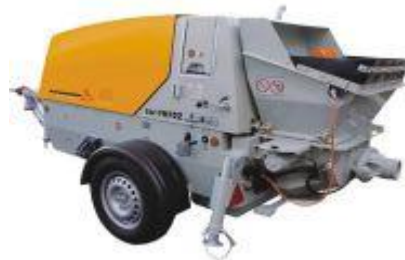
Ilustración 9 bomba compacta de doble pistón
