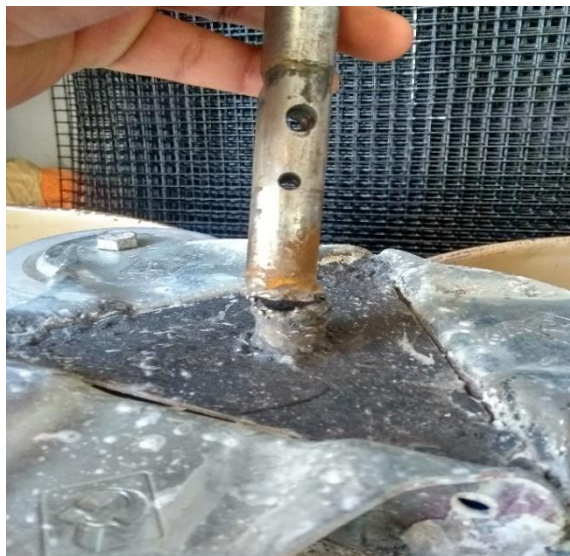
Ilustración 45 ruptura del eje del motor
