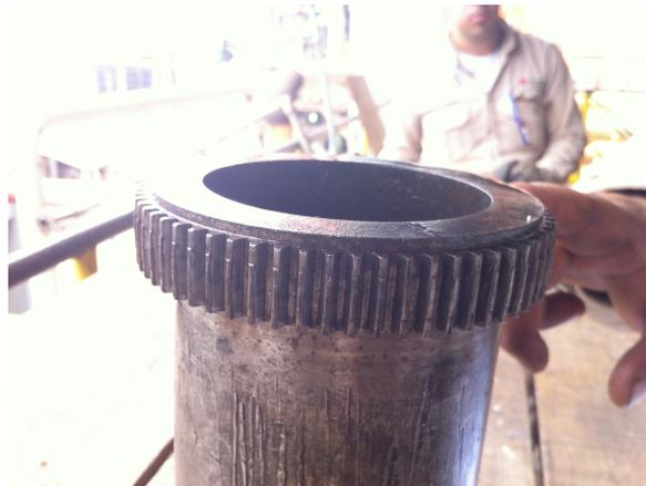
Fig. No. 11. Desgaste de los dientes del cople Turbina-Compresor.
