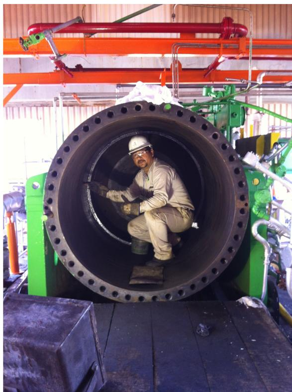
Fig. No. 14. Limpieza del interior de la carcasa del compresor GB-501.
