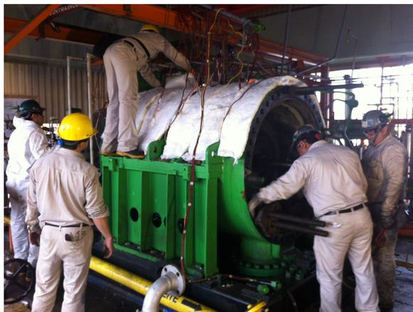
Fig. No. 12. Colocación de resistencias eléctricas para extraer el barril..
