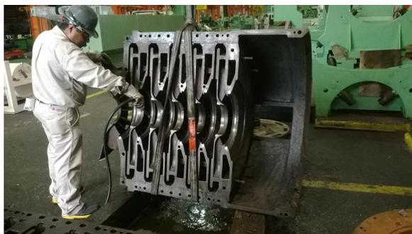
Fig. No. 17. Limpieza de la carcasa del compresor con aire a presión.
