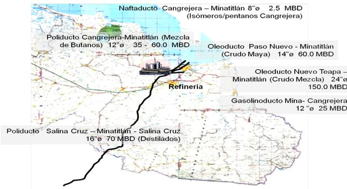
Fig. No. 7. Ductos de entrada hacia la Refinería.
