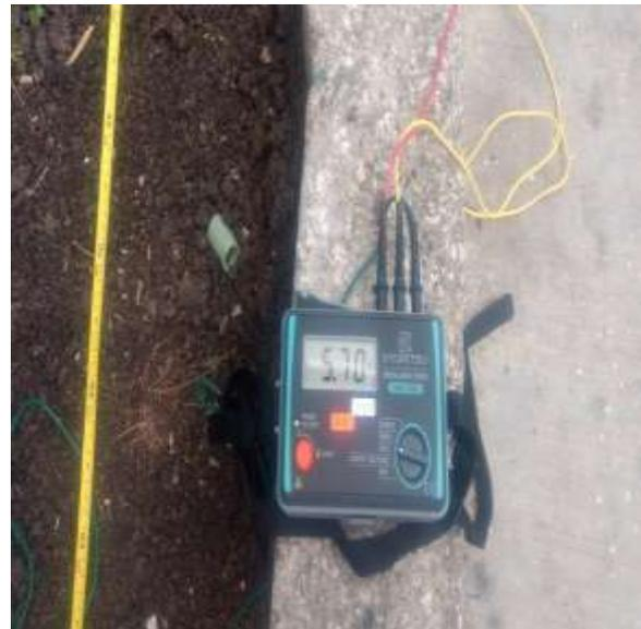
*Figuras 41.- Medición de resistencia a tierra.*
