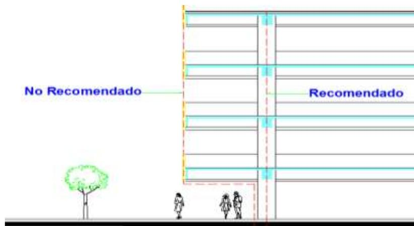
**Figura 22.** -Ruta recomendada para conductores de bajada en edificios con geometrías complejas como la indicada con tránsito de personas.
