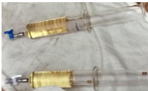
Fig.5.9 Muestras de aceite del transformador.
