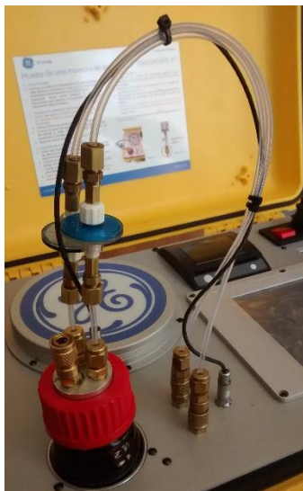
Fig.5.8 Conexiones listas en el equipo para la inyección y análisis de la muestra.
