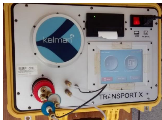
Fig. 5.11 Equipo portátil para cromatografía de gases marca KELMAN.
