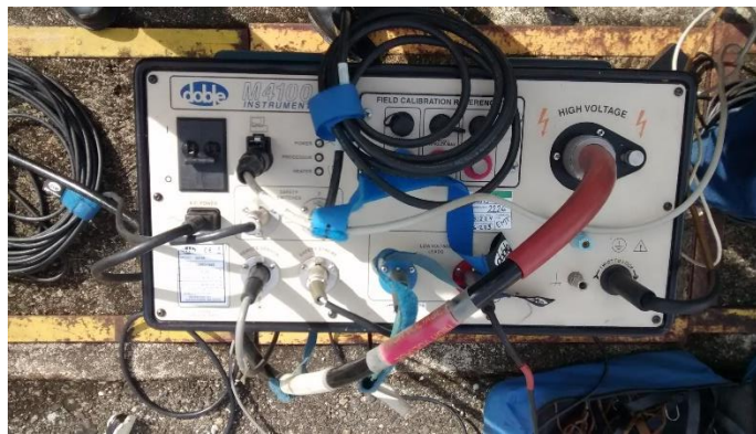
Fig. 5.13 equipo de pruebas M4100 de la Doble.
