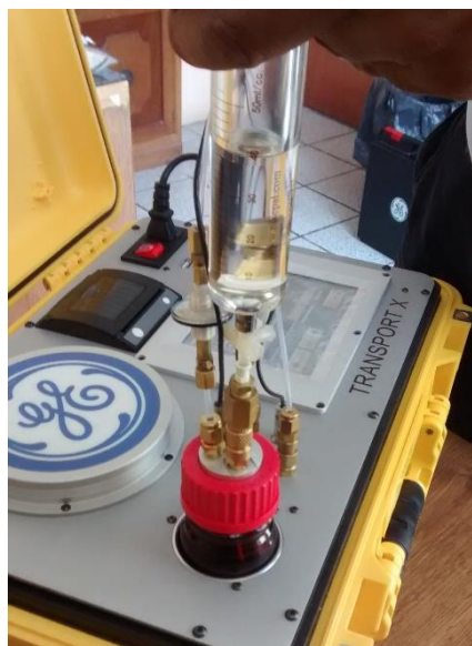
Fig.5.10 Inyectando la muestra de aceite en el equipo.
