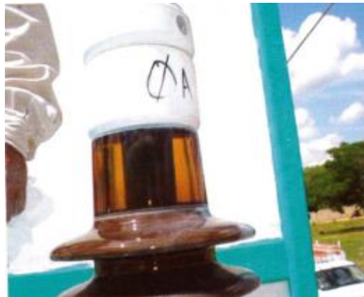
Fig. 4.2 Perdida De Hermeticidad, Falla De Los Empaques, Boquilla Llena De Aceite S.E Ticul II.
