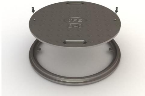
**Material, forma y acabado:** Tapa circular de hierro fundido de diámetro 823mm con acabado antiderrapante. Aro de hierro fundido de diámetro exterior de 915mm interior 835mm.
