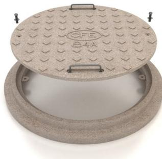
**Material, forma y acabado:** Tapa circular de material polimérico de diámetro 823 mm con acabado antiderrapante con dos asas de fiero redondo con marco de material polimérico con diámetro interior de 835mm. Deberá tener nervaduras para lograr resistencia mecánica al tráfico pesado.
