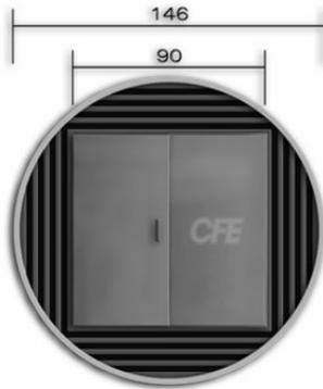
La tapa es de acero y está formada por un bastidor con ángulo de  $\frac{1}{4}$ " x 3" y la lámina de calibre  $\frac{1}{4}$ ".
