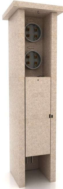
**Material, forma y acabado:** Murete con una sección para medidores y otra para caja de conexiones, fabricado en concreto hidráulico, con resistencia de  $f'c=250 \text{ kg/cm}^2$ . Armado en malla electro soldada con refuerzo de varilla con diámetro de 9.525 mm. o fabricado en concreto polimérico con resistencia de  $f'c=500 \text{ kg/cm}^2$ .
