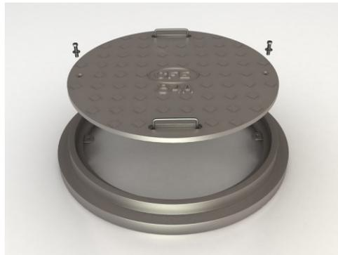
**Material, forma y acabado:** Tapa circular de hierro fundido de diámetro 823mm con acabado antiderrapante. Con dos asas de hierro redondo con marco de hierro fundido de forma cuadrada de 988mm por lado y con diámetro interior de 835mm deberá de tener nervaduras para lograr resistencia mecánica al tráfico pesado.
