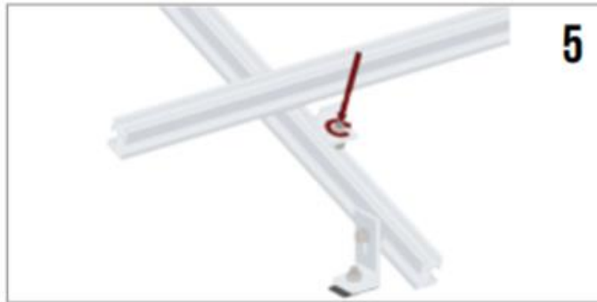
Figura 3.7.4 Muestra de funcionamiento de los tornillos con los sujetadores
