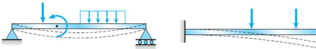
Figura 2. 35 Ejemplos de vigas sometidas a cargas laterales (verticales). (Gere & Goodno, 2009)
