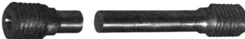
Figura 2. 24 Probeta después de un ensayo de un material frágil. (Beer, Johnston, DeWolf, & Mazurek, 2010)
