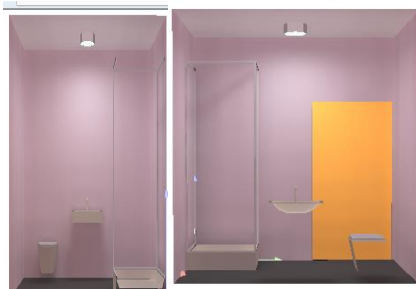
Fig.3.5 Distribución de las luminarias en el baño
