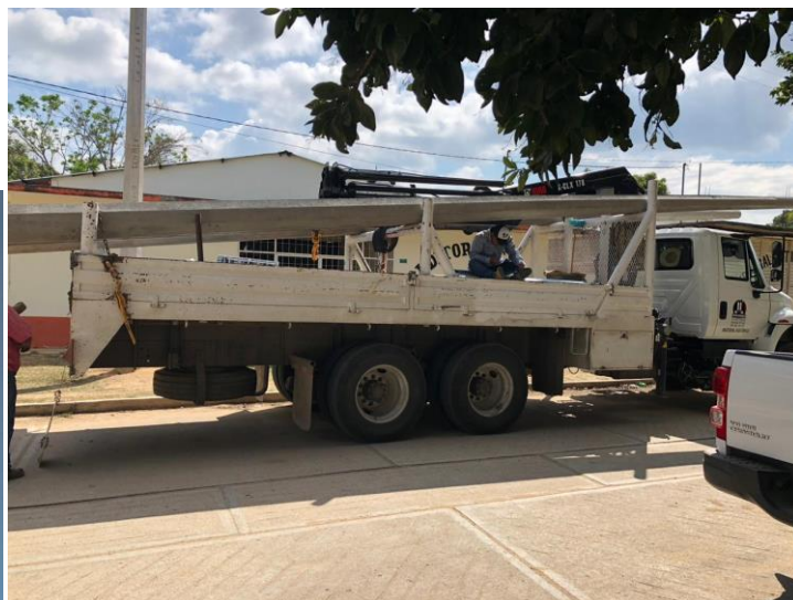
Foto 4 Grúa tipo HIAB para suministro de postes.
