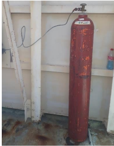
Figura 3.19 Con sello de gas inerte del T-9 MPU
