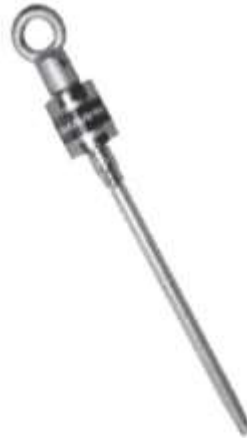
Ilustración 14. Herramienta de Torsión para instalar la boquilla inserto. [10]
