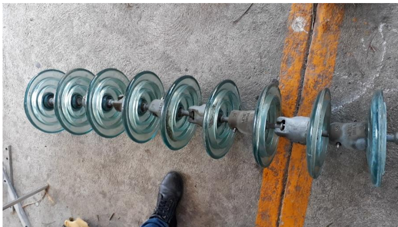
Ilustración 8 Cadena de Aisladores de Vidrio Templado.
