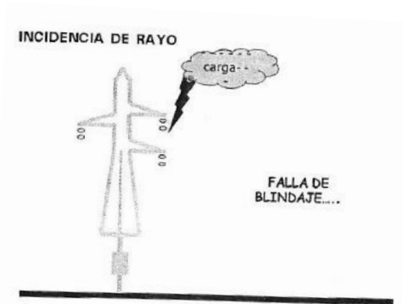
Ilustración 22 Falla de Blindaje.
