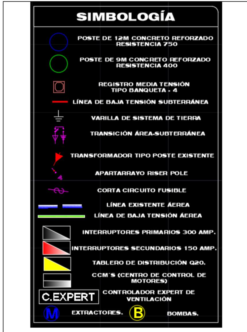
Tomando en cuenta que el sitio tiene 4 salas de gestación porcina automatizadas. Se ejemplifica la distribución del conductor principal y el secundario que viajan hasta las casetas, ITM'S, centros de carga, CCM'S y equipos eléctricos.
