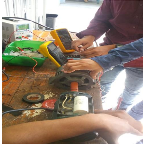
Figura 54 Prueba con acoplamiento directo
