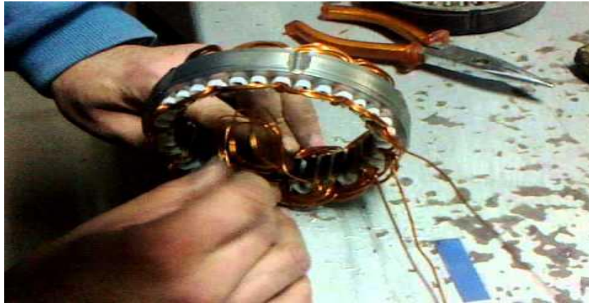
Figura 52 Rebobinado para 127v CA
