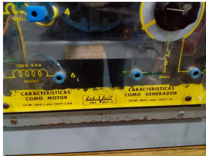
Figura 61 Características de motor CD
