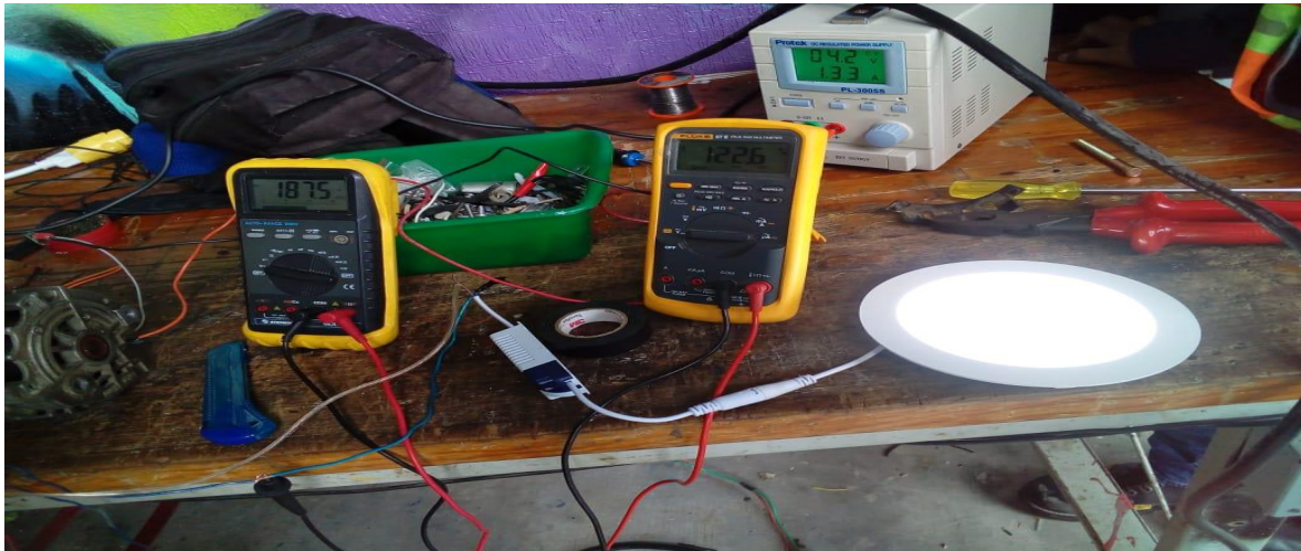
Figura 56 Pruebas con carga en las terminales de salida
