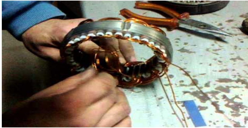
Figura 52 Rebobinado para 127v CA
