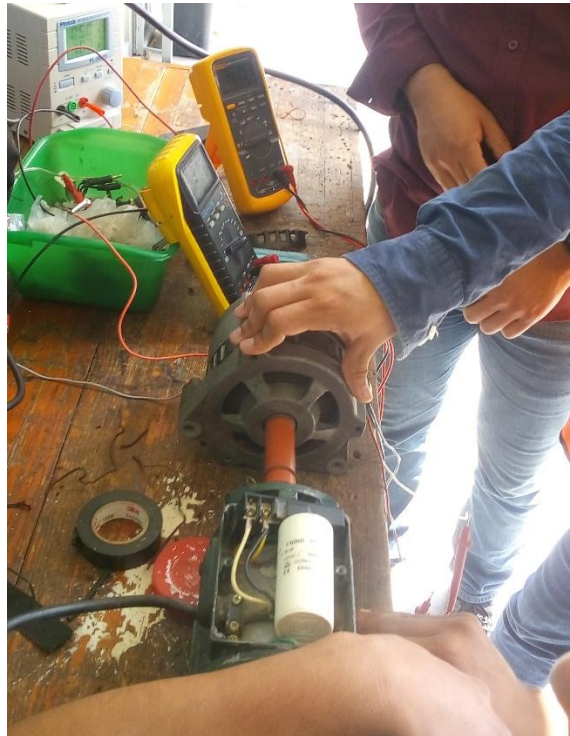
Figura 95 Acoplamiento directo de generador síncrono
