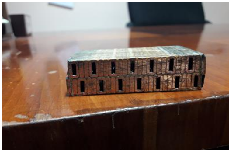
Figura 12. Trozo de barra de cobre hueco para generador con enfriamiento por agua.
