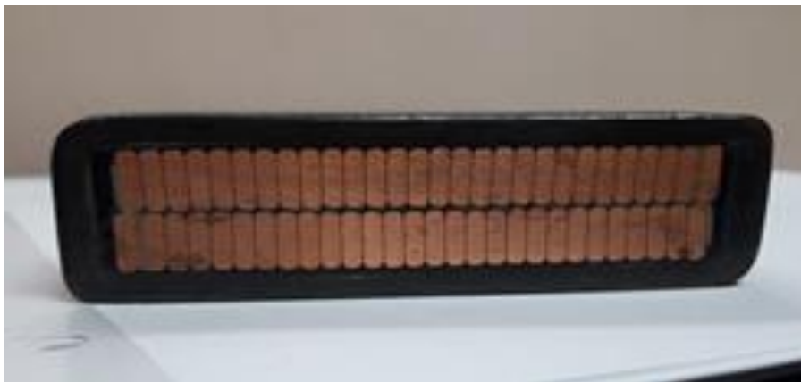
Figura 10. Trozo de barra de embobinado con enfriamiento por aire.
