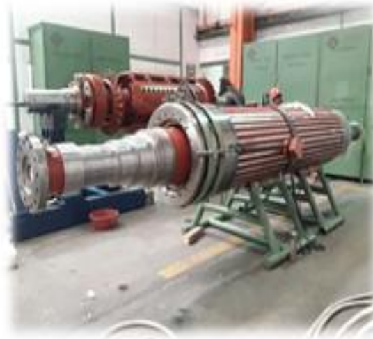
Figura 8. Rotor tipo cilíndrico de 2 polos lisos.
