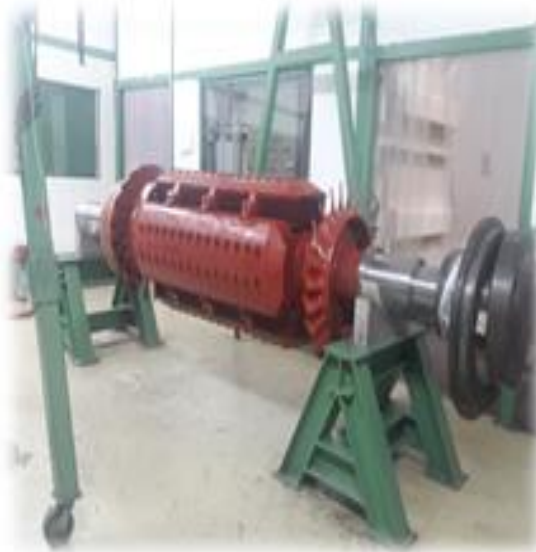
Figura 6. Rotor de 4 polos salientes de un alternador.
