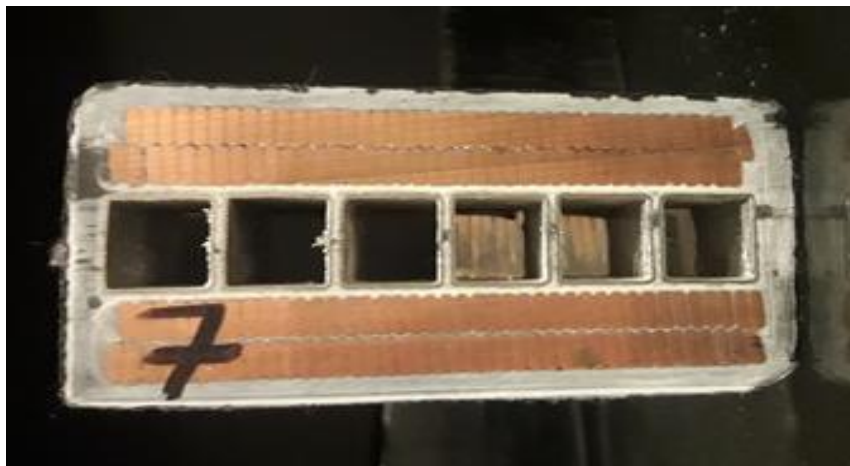
Figura 11. Trozo de barra con tubos de acero inoxidable para el enfriamiento por hidrogeno.
