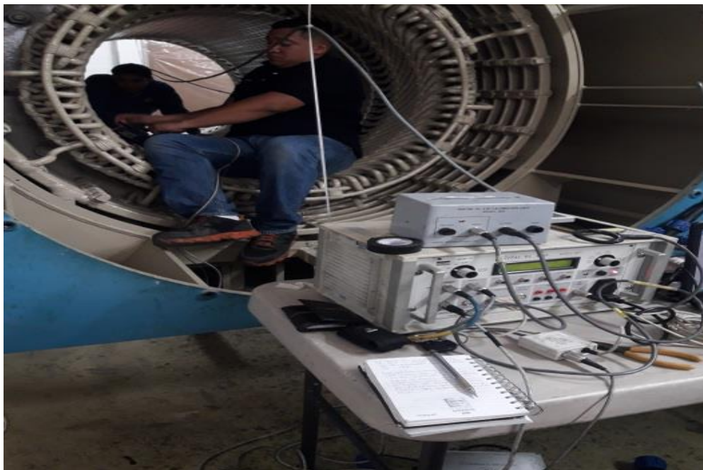
Figura 18. Realización de la prueba del CID.
