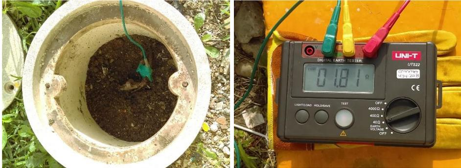
*Figura 4.5.- Medición del sistema de puesta a tierra.*
