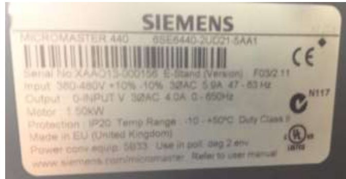
Anexo 4 Datos de placa del variador de frecuencia
