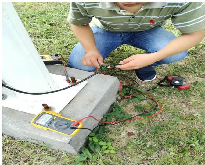
*Figura 13: Medición real del Voc.*
