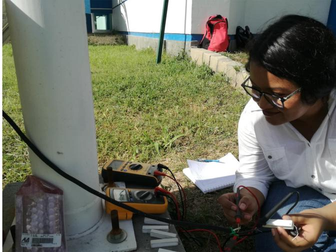
*Figura 18: Medición de voltaje con carga resistiva pura .*
