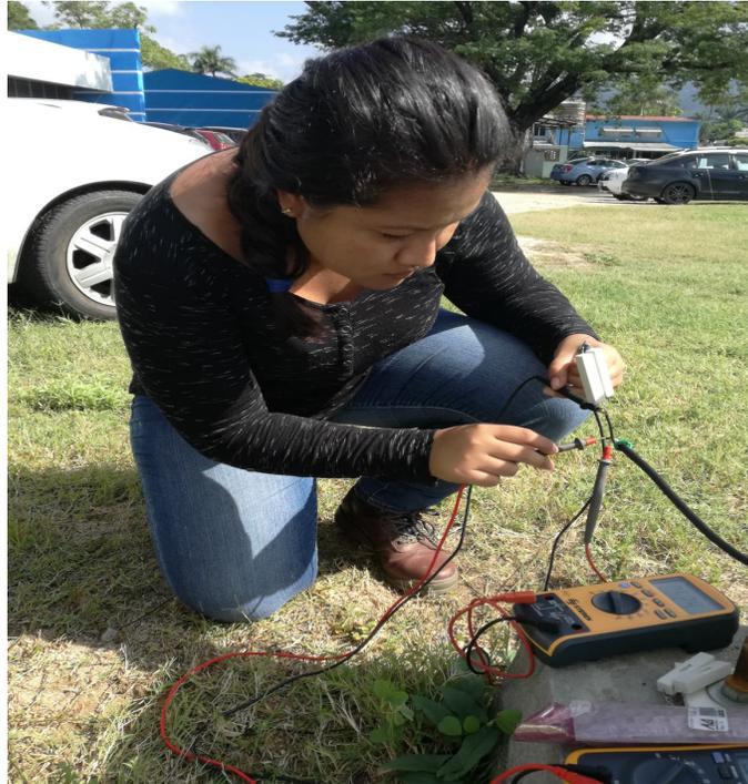
*Figura 20: Medición de  $I_{sc}$  con cargas resistivas en paralelo.*
