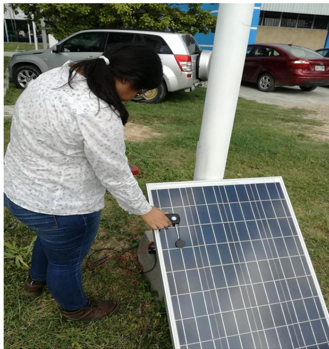
*Figura 15: Medición real de irradiancia.*
