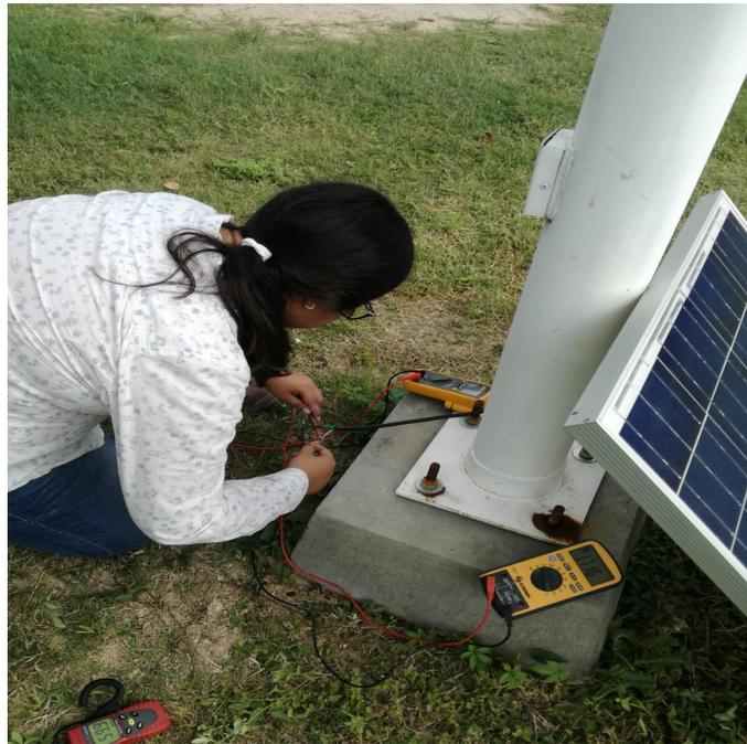
*Figura 14: Medición real de la  $I_{sc}$ .*
