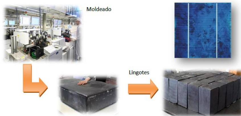
Figura 7. Proceso de elaboración de células fotovoltaicas.
