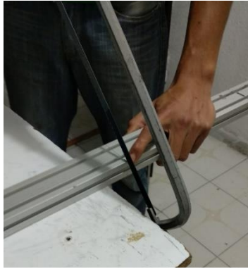
Fig. 4.5 Corte de aluminio estructural
