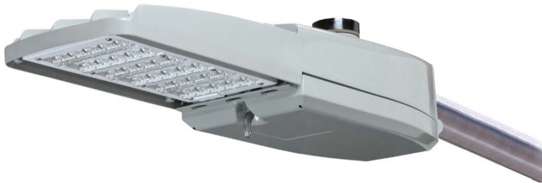
Figura 2.9 a) Luminaria LED luz,fría 80W, 8155 lúmenes, *ATB0 30BLED 85.
