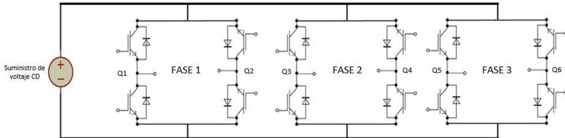
**Figura 24. Puentes de IGBT's para fuente trifásica.**
