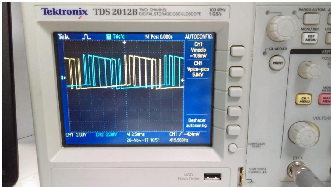
**Figura 33. Salidas de PWM abarcando el área bajo la curva de la onda senoidal**
