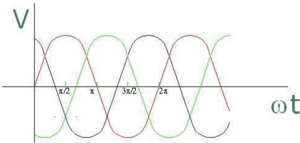
Figura 15. Onda trifásica de un transformador sin rectificar
