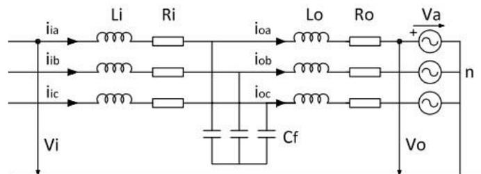
**Figura 34. Diseño del circuito trifásico LCL.**
