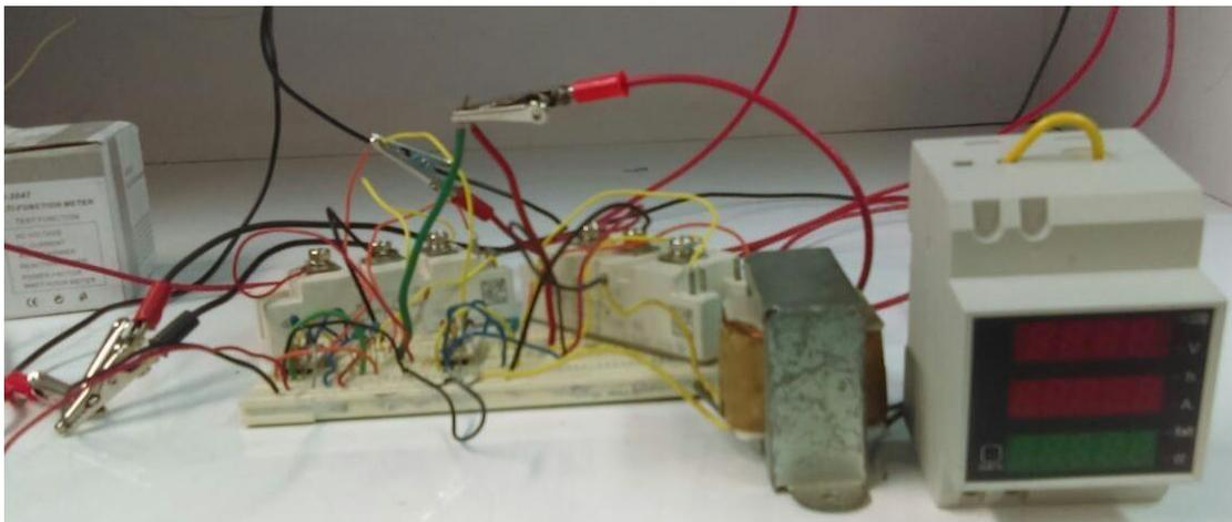
*Figura 36. Acoplamiento del indicador a la etapa de control*
