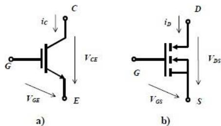
**Figura 7. Representación simbólica del transistor IGBT. a)**
