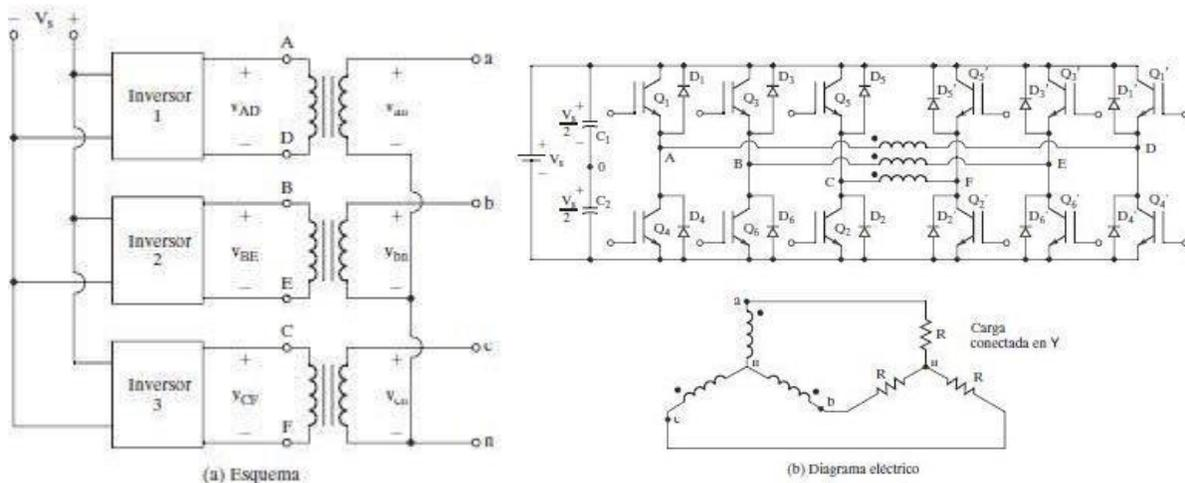
Figura 17. Inversor trifásico formado por tres inversores monofásicos
