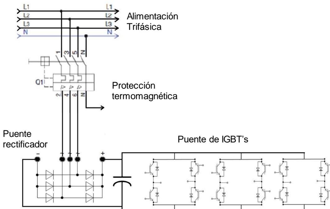
Figura 28. Circuito representativo del diseño de la fuente trifásica
