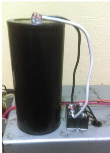
**Figura 27. Conexión de la salida del rectificador al capacitor**
