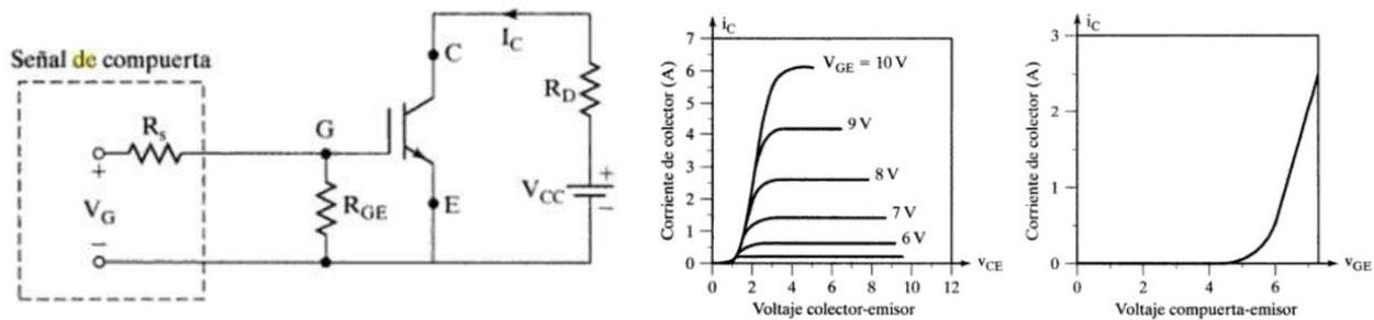
**Figura 9,9(a),9(b). Símbolo, circuito, características típicas de salida y de transferencia de los IGBT's**
