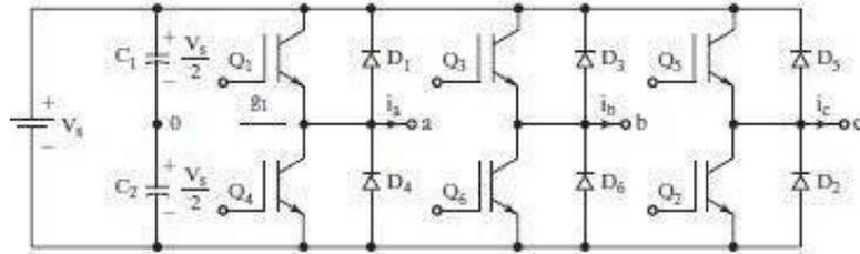
**Figura 18. Puente inversor trifásico**
