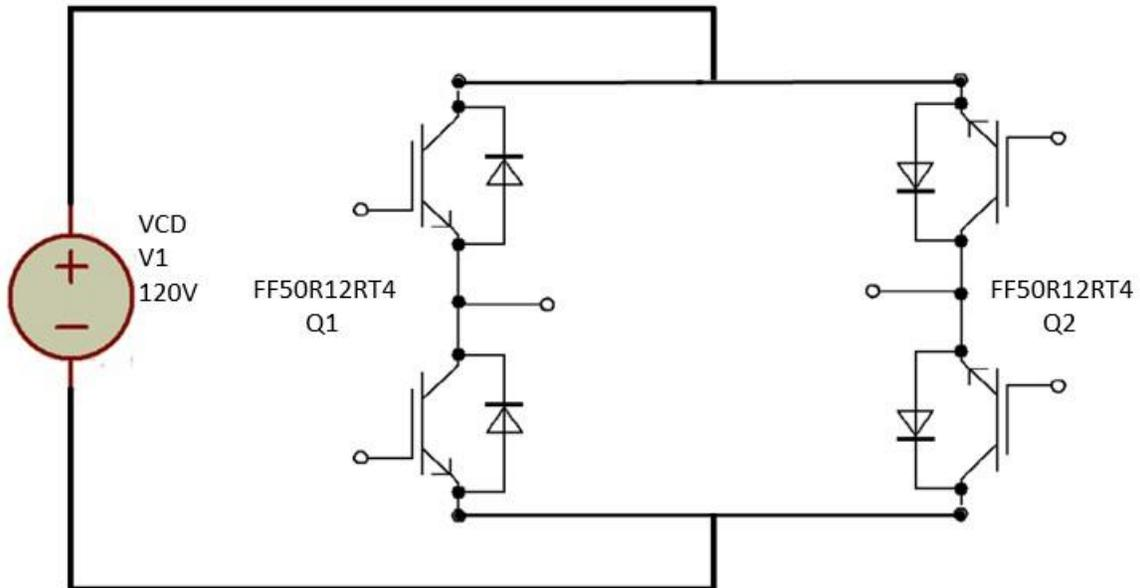
*Figura 23. Diagrama de puente H con IGBT's.*
