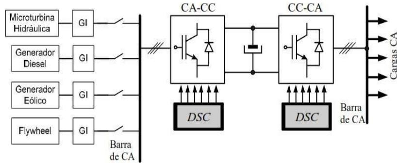
**Figura 3. Esquema de micred basada en fuentes renovables de energía con interface CA-CC-CA**
