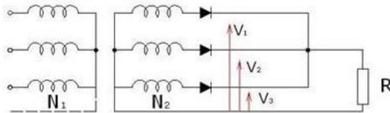
Figura 14. Rectificación trifásica media onda.
