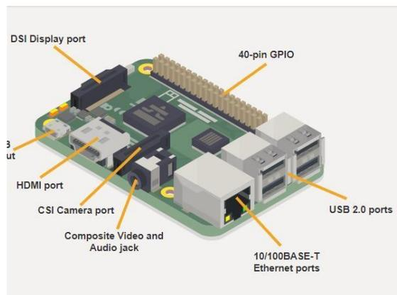
**Figura 10. Conexiones y expansiones**
