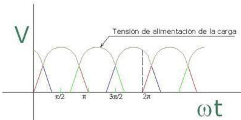
Figura 16. Onda trifásica de un transformador rectificada.
