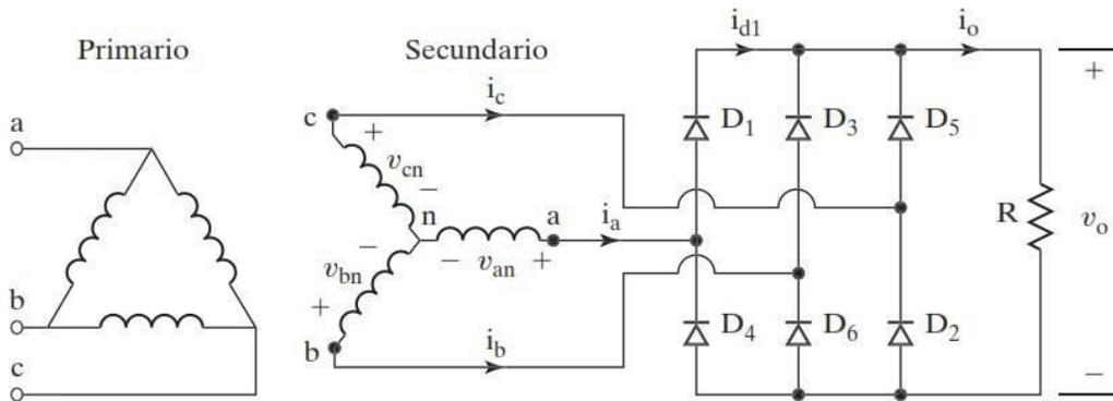
Figura 12. Rectificación trifásica en puente.
