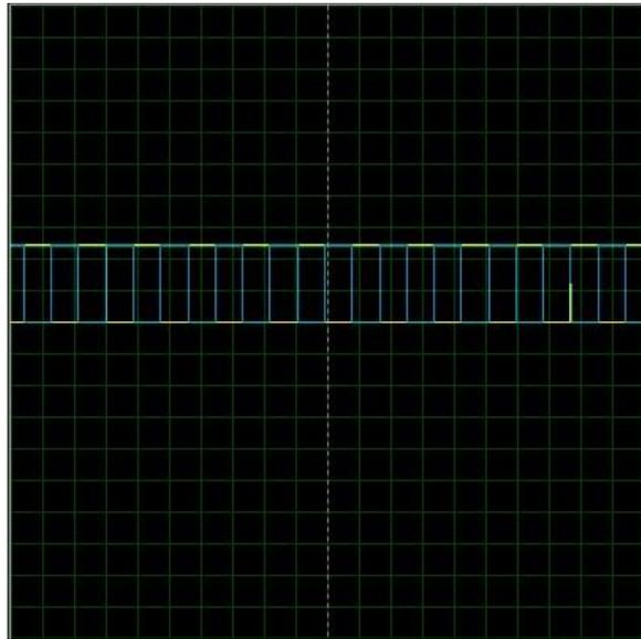
*Figura 38. Señales de salida de los pulsos PWM*
