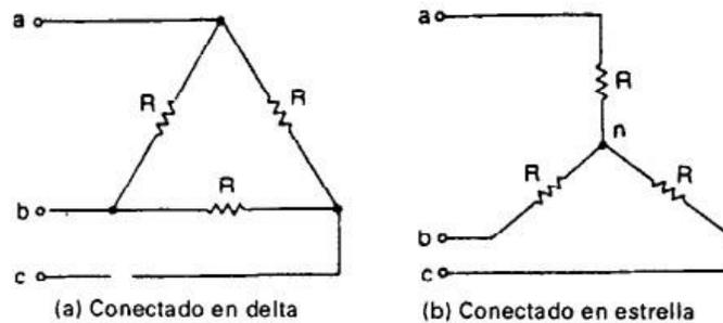
Figura 20. Carga conectada en delta y en Y
