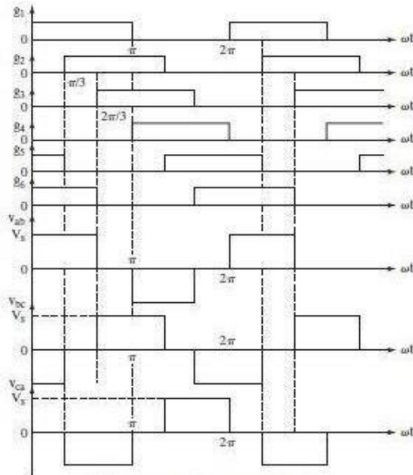
Figura 19. Formas de onda durante conducción de  $180^\circ$
