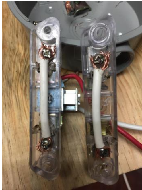
Imagen 32: baquelita transparente con puente en las fases con conductor #8 AWG.
