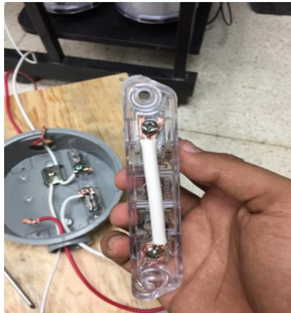
Imagen 25: puente en baquelita transparente por el lado de la fase con calibre #8 AWG.
