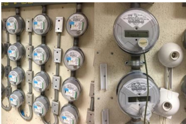
Imagen 13: instalación de los chupones para ingreso de prueba funcional.
