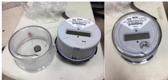
Imagen 35: capelo nuevo, antes y después de su instalación.
