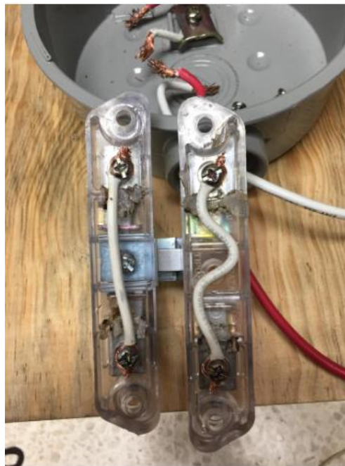
Imagen 30: base de medición puenteada en baquelitas transparentes con conductor calibre #12.
