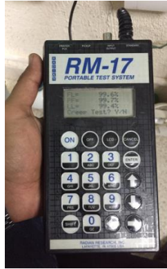
Imagen 36: prueba de cargas con equipo RM-17.
