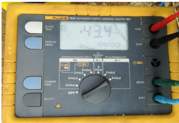
Figura 61.-Se utiliza la escala de 3 kΩ a 4 polos, con una distancia de 4 mts entre electrodo.
