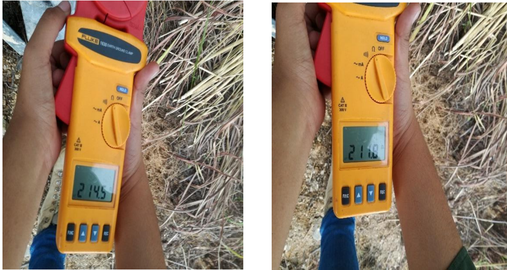
Figura 57.-La resistencia de la pata 2 tiene un valor de 214.5 \Omega , aquí se trabaja para la mejora del sistema a tierra.
