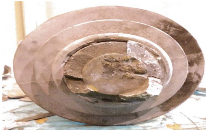
Figura 7.- La columna de varistores del apartarrayos consta de tres secciones, acopladas mediante conexiones metálicas, todo cubierto por concreto polimérico y una cubierta polimérica.
