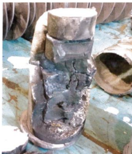
Figura 6.- Se evidencia la circulación de la corriente de falla a través de los varistores y no en la interface de estos con la resina epóxico.
