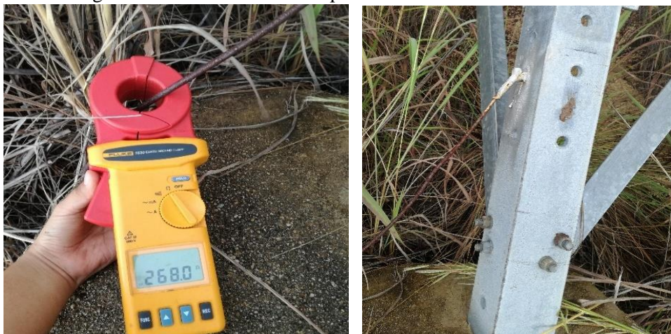
Figura 56.-La resistencia de la pata 3 tiene un valor de 268 \Omega .
