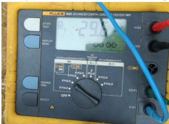
Figura 62.-Se utiliza la escala de 300 kΩ a 4 polos, con una distancia de 4 mts entre electrodo.
