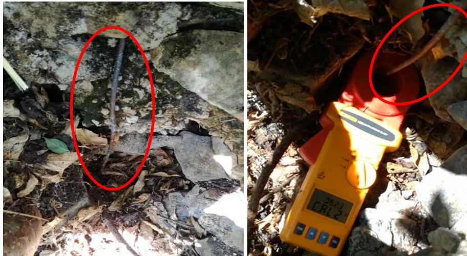
Figura 47.-Medición del sistema de tierra en la pata 3 a la estructura 6 en la línea 73810.
