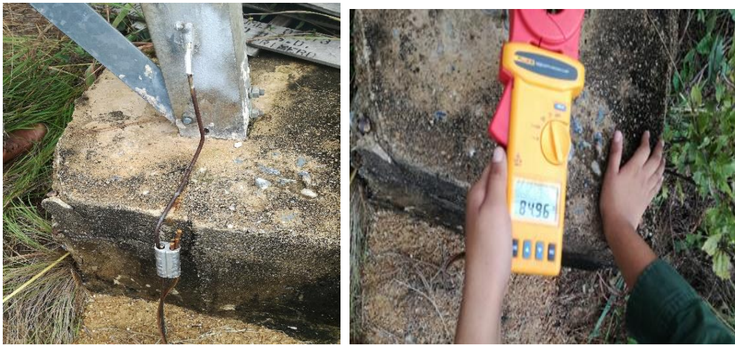
Figura 55.-La resistencia de la pata 4 tiene un valor de 84.96 \Omega .
