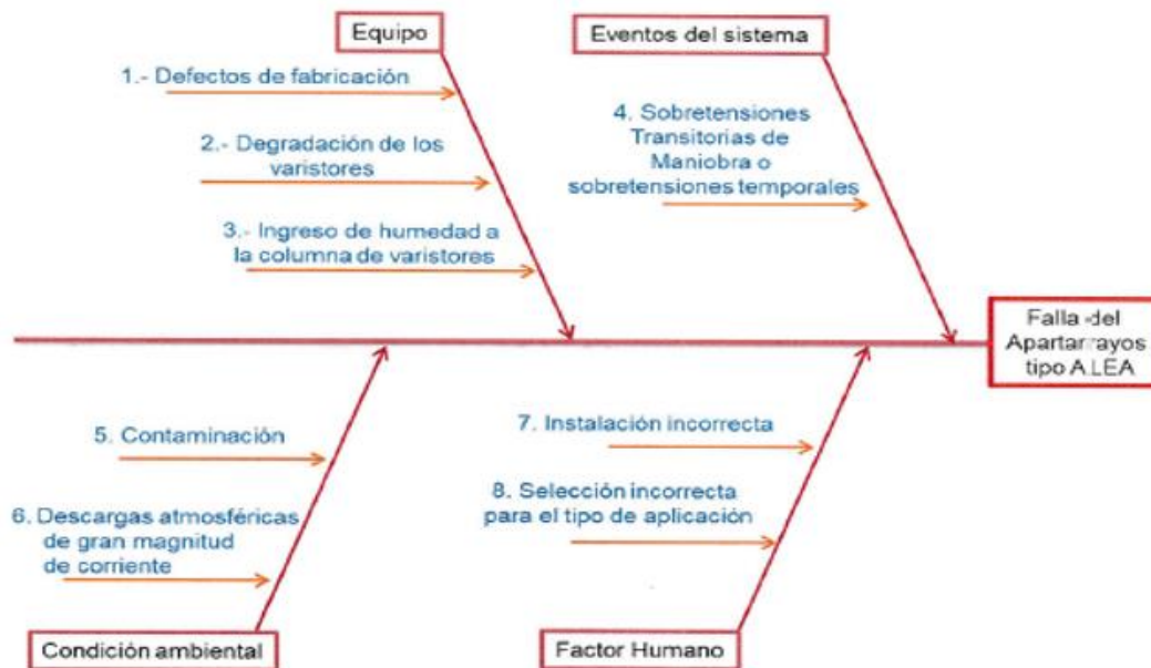
Figura 8.- planteamiento de hipótesis de falla y del modo de falla más probable
