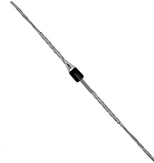
Fig. 2.4.7.3 Sujeción de cable de retenida en aislador R
