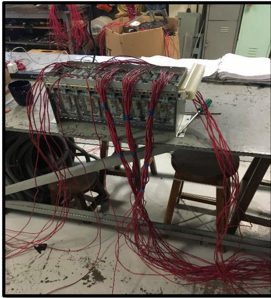
Figura 9. Armado de circuitos para simulación apertura y cierre de interruptores a través de relevadores biestables ASEA
