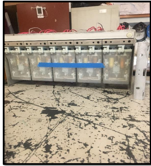
Figura 9. Armado de circuitos para simulación apertura y cierre de interruptores a través de relevadores biestables ASEA
