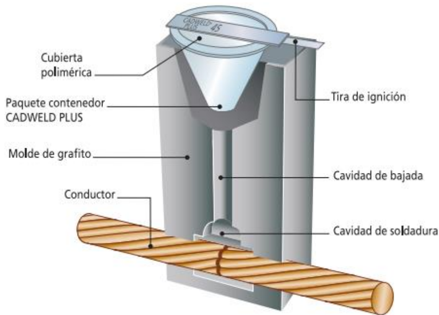
Fig. 2.15 Paquete de conexión exotérmica.
