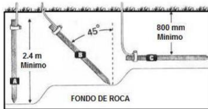
Fig. 2.2 Instalación de electrodo de tierra tipo varilla.
