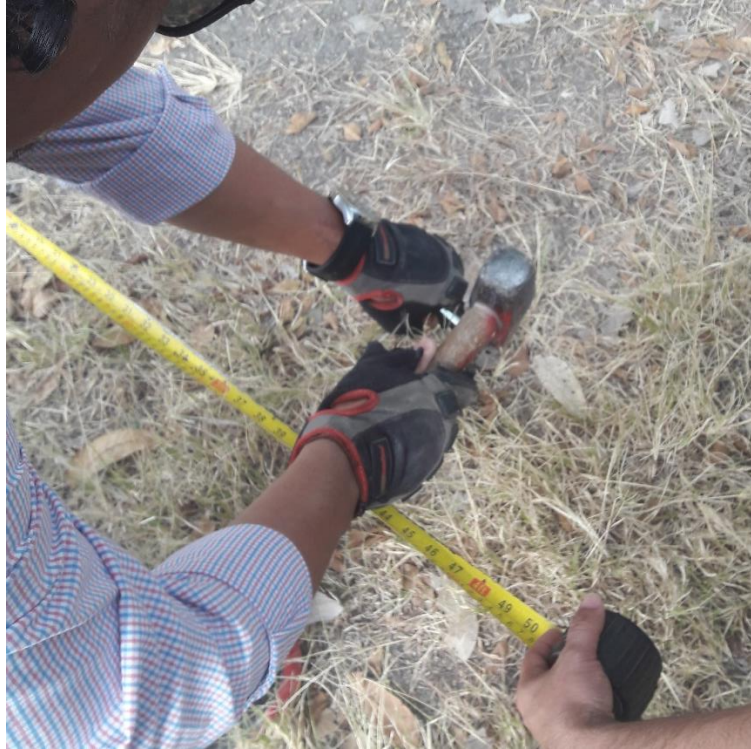
Fig. 3.4 Medición y colocación del primer electrodo de prueba.
