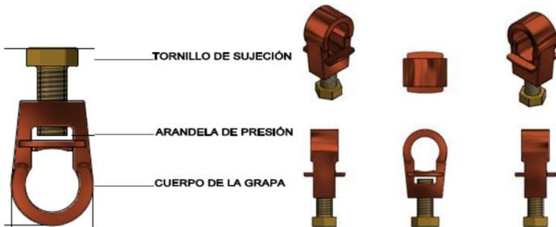
Fig. 2.12 Conector tipo tornillo con arandela.
