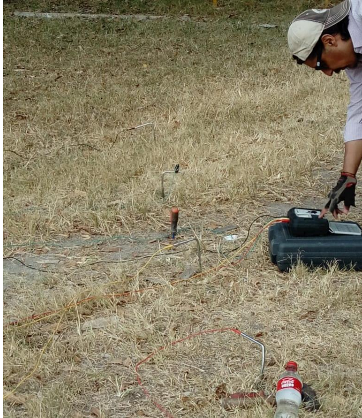
Fig. 3.5 Electrodo enterrados a 5 cm y espaciados a 1 m para realizar la primera medición
