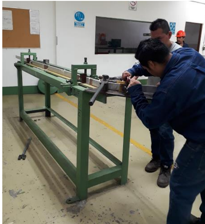
Figura 46. Proceso de formación de la barra Roebel, completamente aislada.
