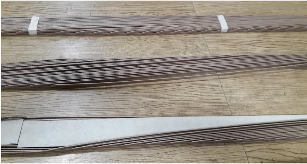
Figura 45. Aislamiento de la barra Roebel
