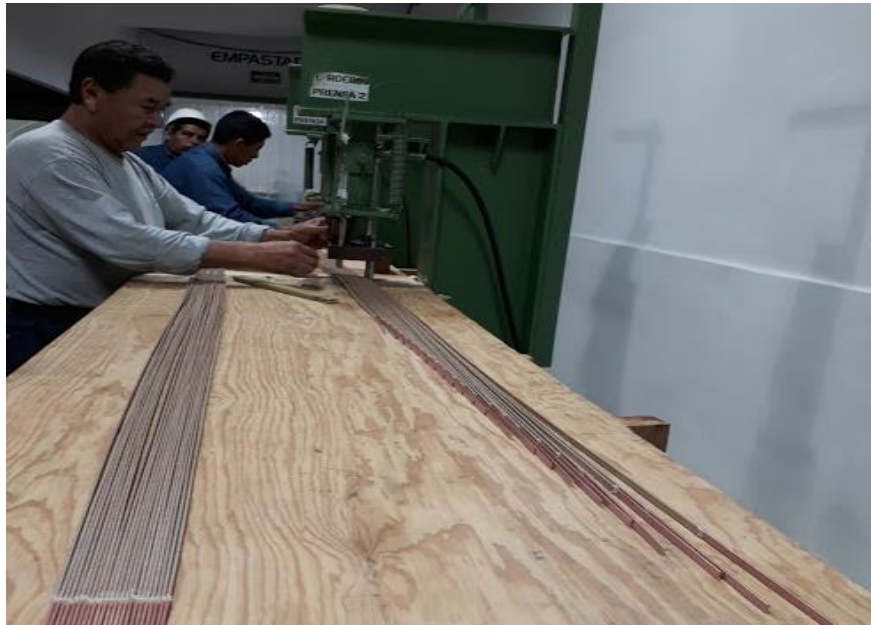
Figura 43. Agrupación de los hilos de cobre para formar una barra Roebel
