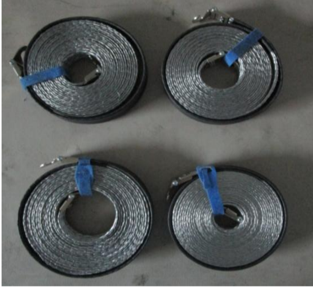
Figura 39. Cables a tierra
