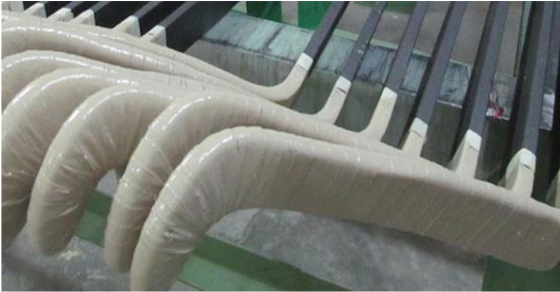
Figura 47. Aislamiento de la barra Roebel
