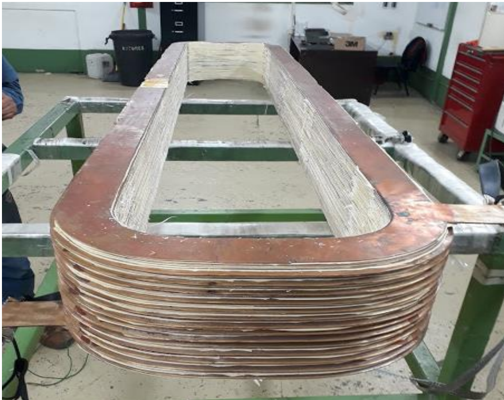
Figura 19. Bobina polar al que se realizó la prueba de barrido
