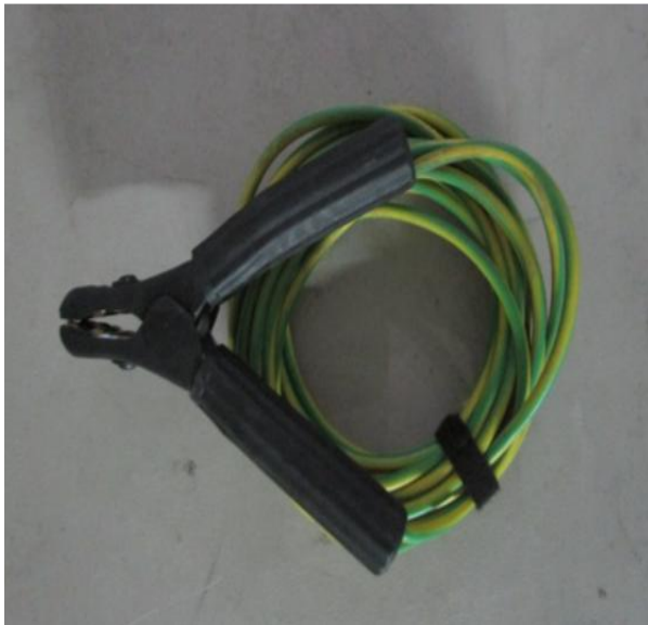
Figura41. Cable a tierra
